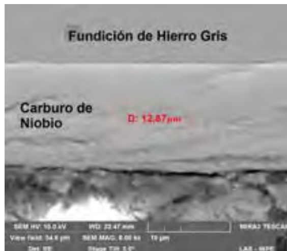
Ilustración 4. Micrografía SEM a 8000x de un recubrimiento de carburo de niobio depositado por TRD, sobre fundición gris a 1273K por 4 h.
