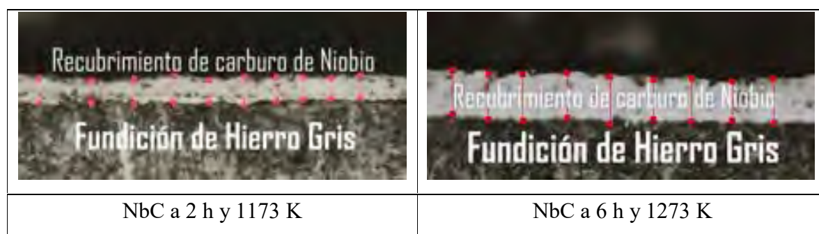
Ilustración 42. Ejemplo de medición de espesores de la capa de recubrimiento de carburo de niobio usando Microscopio óptico Leco IA32 a 2000X.
