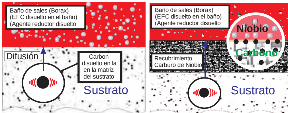
Ilustración 6. Diagrama descriptivo de los mecanismos de formación de la capa de carburo de niobio.
