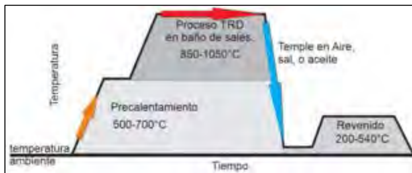
Ilustración 5. Diagrama descriptivo típico de temperatura contra tiempo de un proceso de depósito por TRD.
