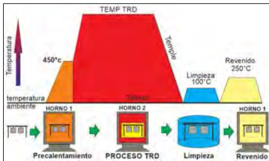
Ilustración 23. Diagrama de proceso en función de la temperatura y el tiempo usado en el proceso de depósito por TRD.
