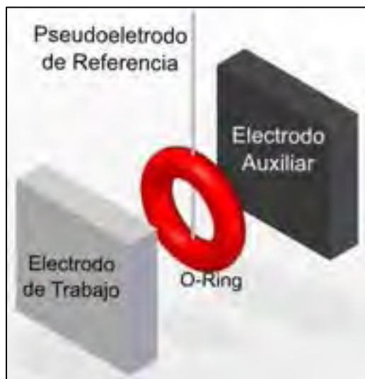
Ilustración 30. Diseño de electrodos para ensayo EIS en medios no electroquímicos con configuración de 3 electrodos.
