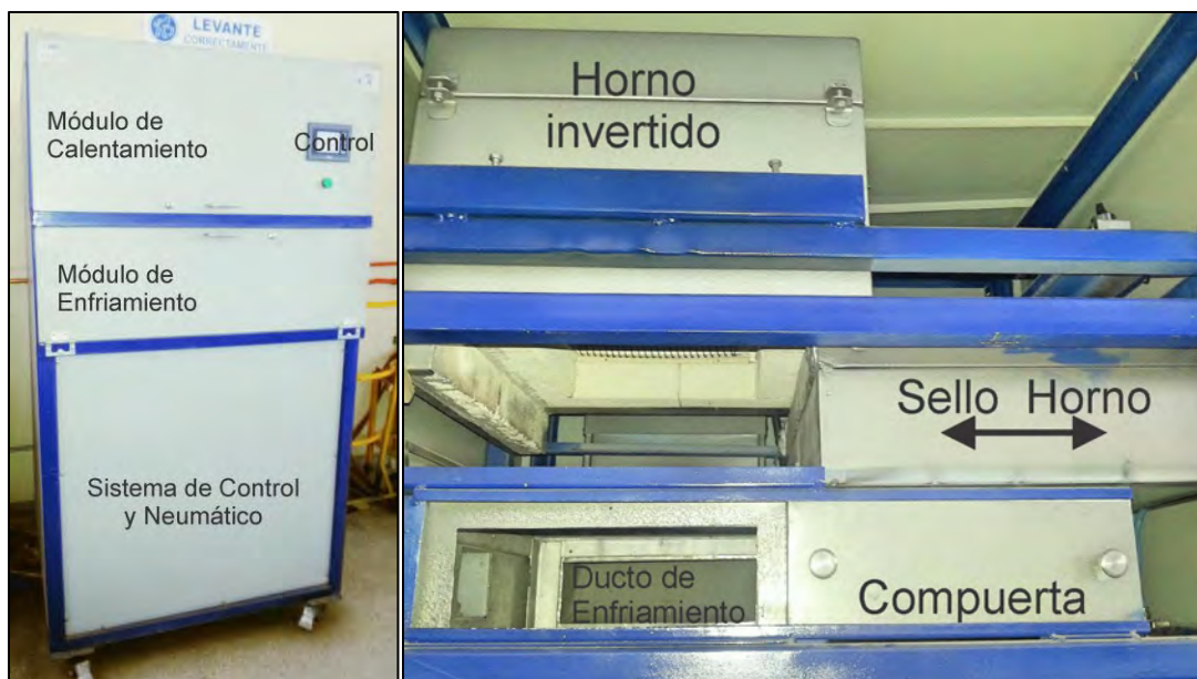
Ilustración 26. Horno automático de fabricación propia usado en los ensayos de inmersión estática en condición de oxidación cíclica.
