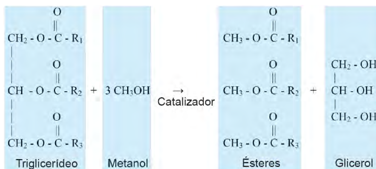
Ilustración 1. Reacción de transesterificación por vía metílica para la producción de biodiesel [49].
