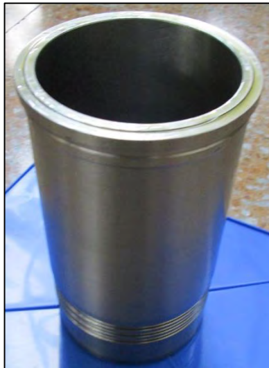
Ilustración 33. Camisa comercial serie 3126 para motor diesel NPH.
