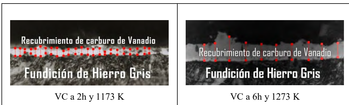
Ilustración 54. Ejemplo de medición de espesores de la capa de recubrimiento de carburo de vanadio usando Microscopio óptico Leco IA32 a 2000X..
