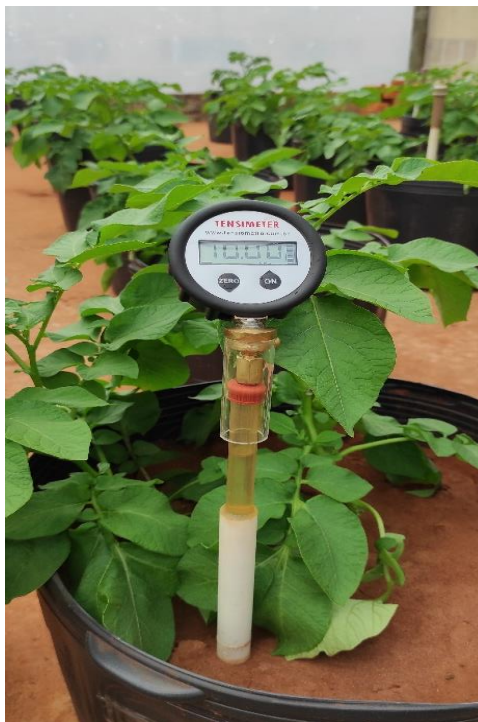
Figura 2- Tensiômetro instalado próximo a zona radicular das plantas
