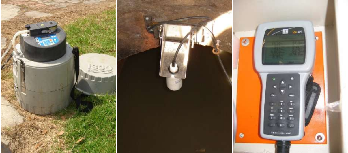
Ilustración 15. Instrumentación instalada en el alcantarillado del campus. Izquierda: muestreador ISCO instalado en el pozo Estadio. Centro: sensor de nivel instalado en el pozo LEH. Derecha: sonda multiparamétrica, localizada en el pozo LEH.
