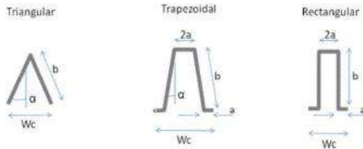
Figura 18. Geometrías típicas de lo vertedero “pico de pato”
