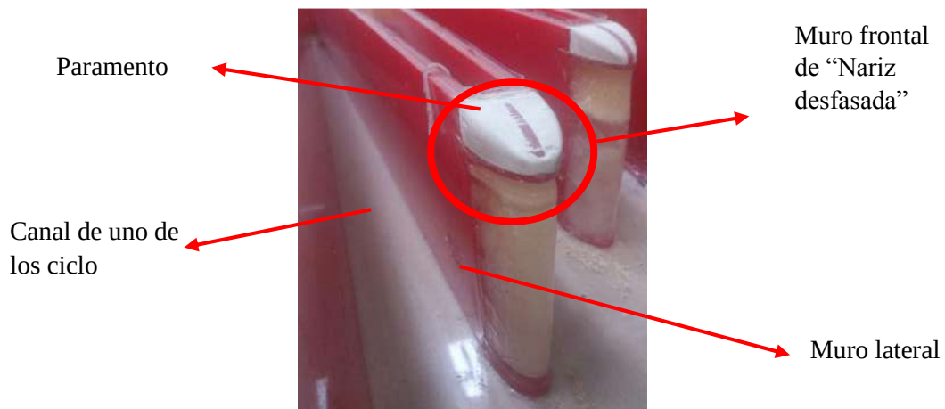
Figura 28. Detalle del muro frontal con geometría "nariz desfasa". Fuente: Fotografía propia.
