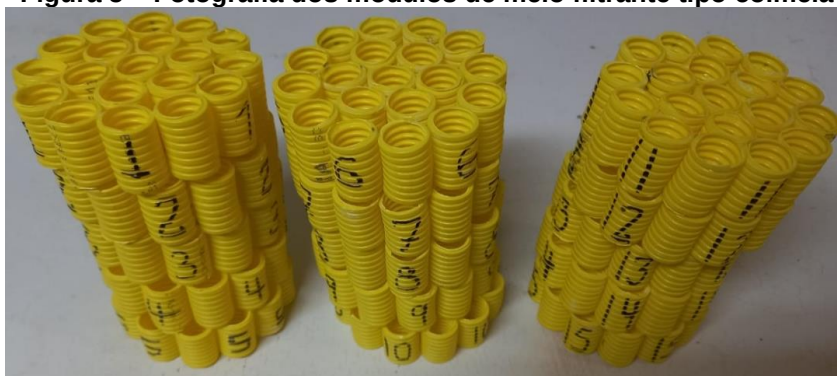
Figura 5 – Fotografia dos módulos de meio filtrante tipo colmeia
