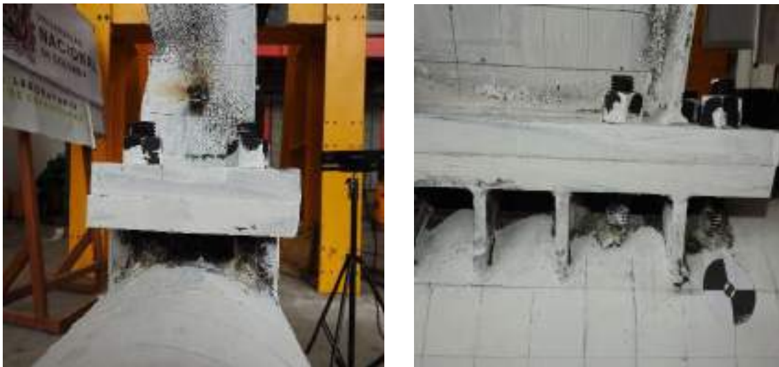
Figura 6.19-1.- Placa base en conexión PTE 323.9 x10 -W18x35 2-2
