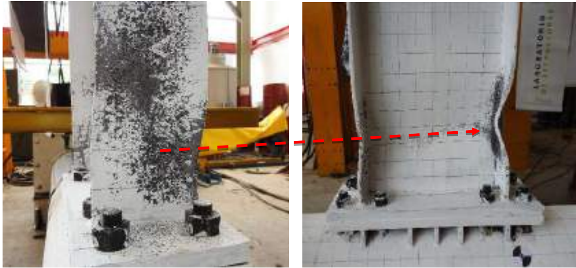
Figura 6.7-1-Figura 6.7-2.-Deformación en patines de viga y rastro de rotula plástica.
