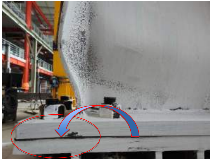
Figura 6.3-3.-Flexión en la platina por efecto de apalancamiento
