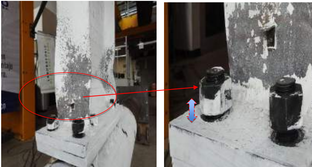
Figura 6.4-1-Figura 6.4-2.-Pernos sueltos por efecto de apalancamiento
