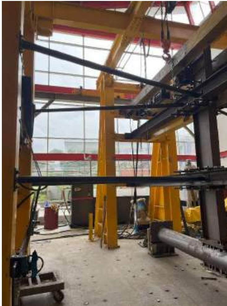
figura 5-1.-Montaje en actuador Dinámico
