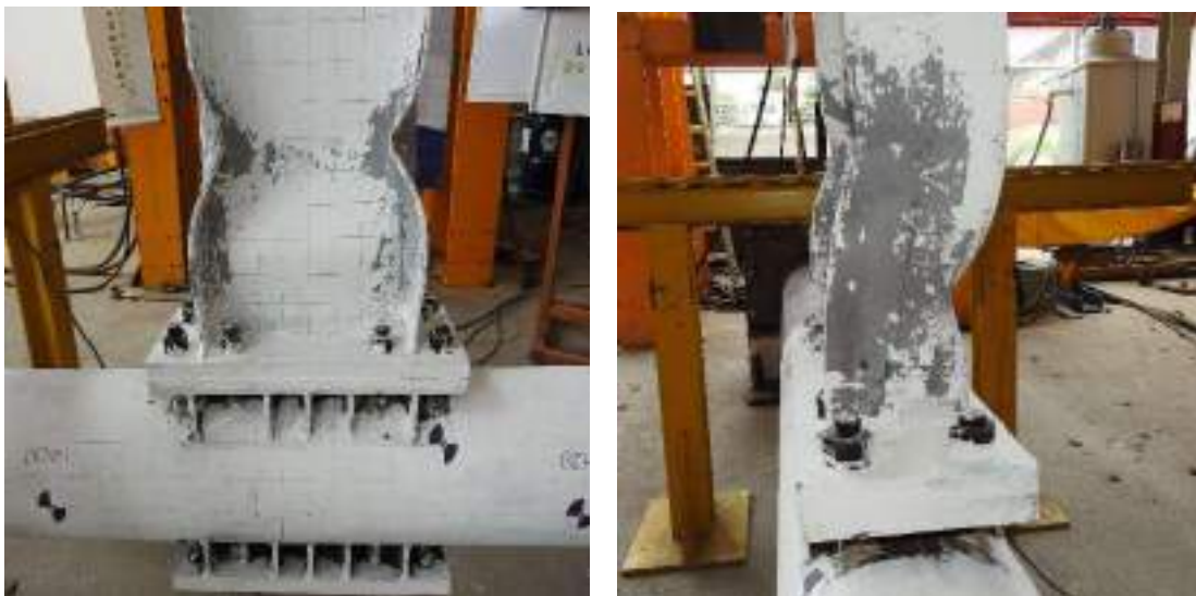
Figura 6.13-3-Figura 6.13-4.-Deformación en el alma de la viga PTE 323.9 x10 -W18x35 2-1
