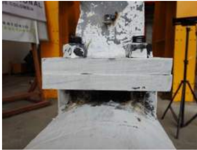
Figura 6.15-1.-Pernos después del ensayo PTE 323.9 x10 -W18x35 2-1
