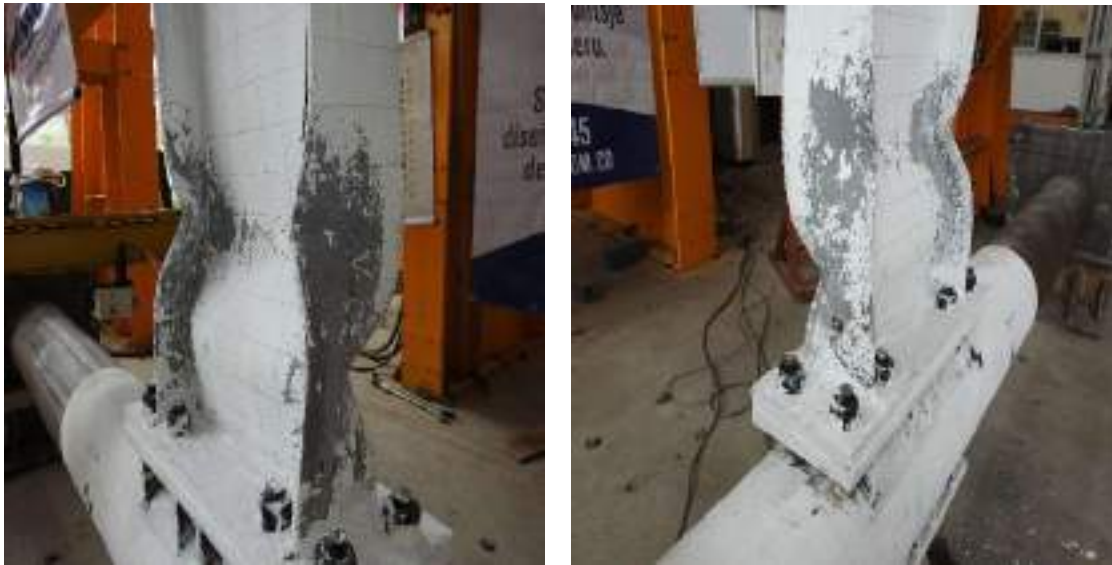
Figura 6.13-1Figura 6.13-2.-Deformación patines PTE 323.9 x10 -W18x35 2-1
