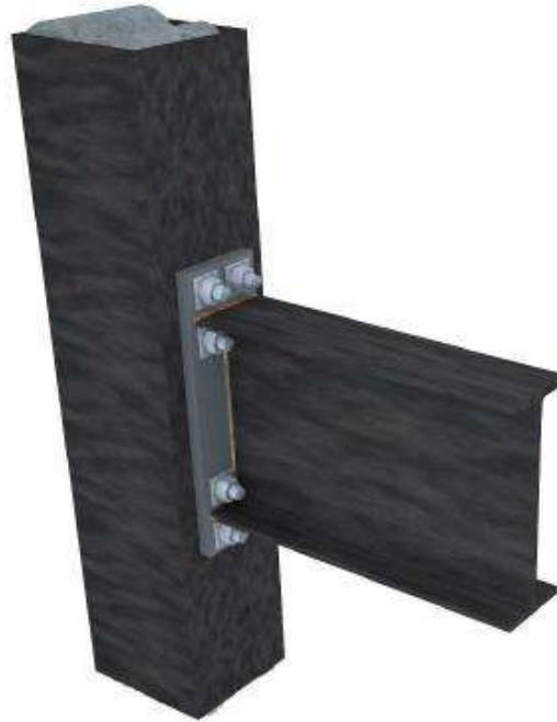
Figura 2.4.2-1.-Conexión PRM viga columna
