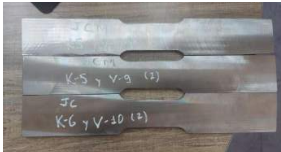
figura 4.3.1-1 Probetas para obtención de F_y de las vigas
