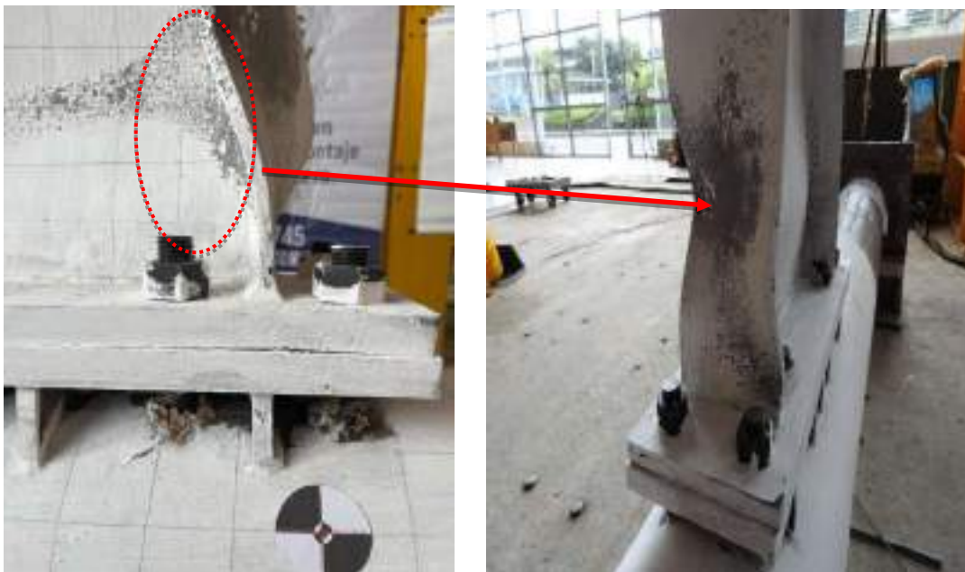
Figura 6.3-1-Figura 6.3-2.-Rotulas plásticas en la viga y deformación en placa base
