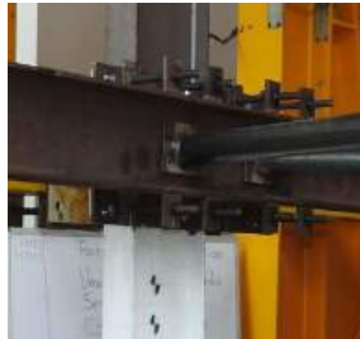
Figura 5.2-1-Figura 5.2-2.-Ajuste de superficie deslizante
