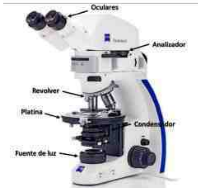
Figura 2-3. Componentes de microscopio óptico Zeiss Primotech. Tomado de Guerrero-Higuera et al. (2023)
