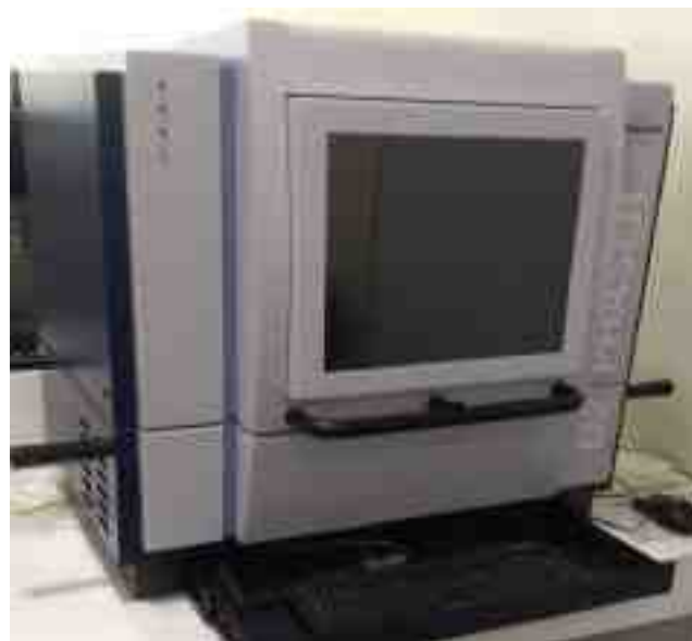
Figura 2-7. Equipo de difracción D2 Phaser marca Bruker Tomado de Guerrero-Higuera et al. (2023)
