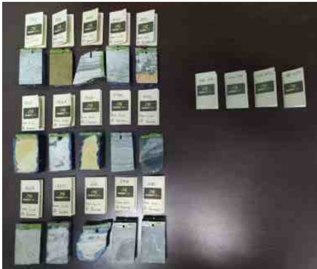
Figura 2-4. Secciones delgadas pulidas (SDP) y testigos de roca impregnados con resina epóxica azul, procedentes de la Quebrada Aguacaliente.
