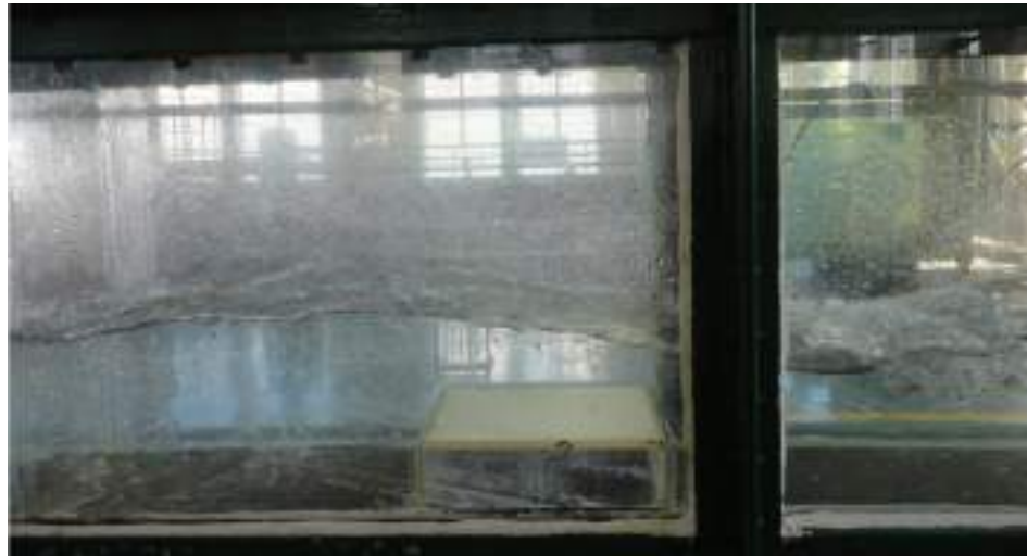
Figura 2.3-14: Caída hidráulica en el obstáculo y posterior resalto, para el ensayo 5.
