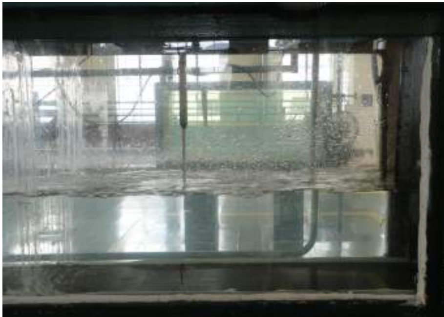
Figura 2.3-6: Profundidad del agua hacia aguas abajo, para el ensayo 2
