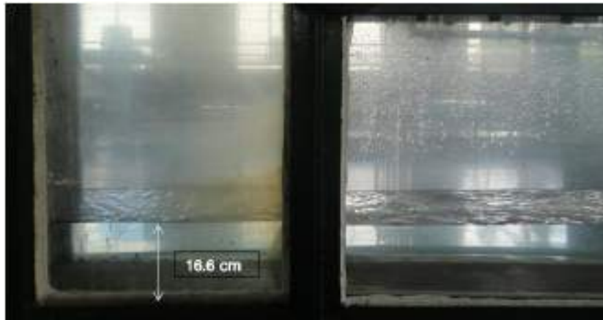
Figura 2.3-22: Resalto hidráulico causado por la interferencia de las capas de silicona, para el ensayo 8.
