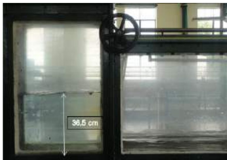
Figura 2.3-2: Flujo aguas arriba y aguas abajo de la compuerta, para el ensayo 1.
