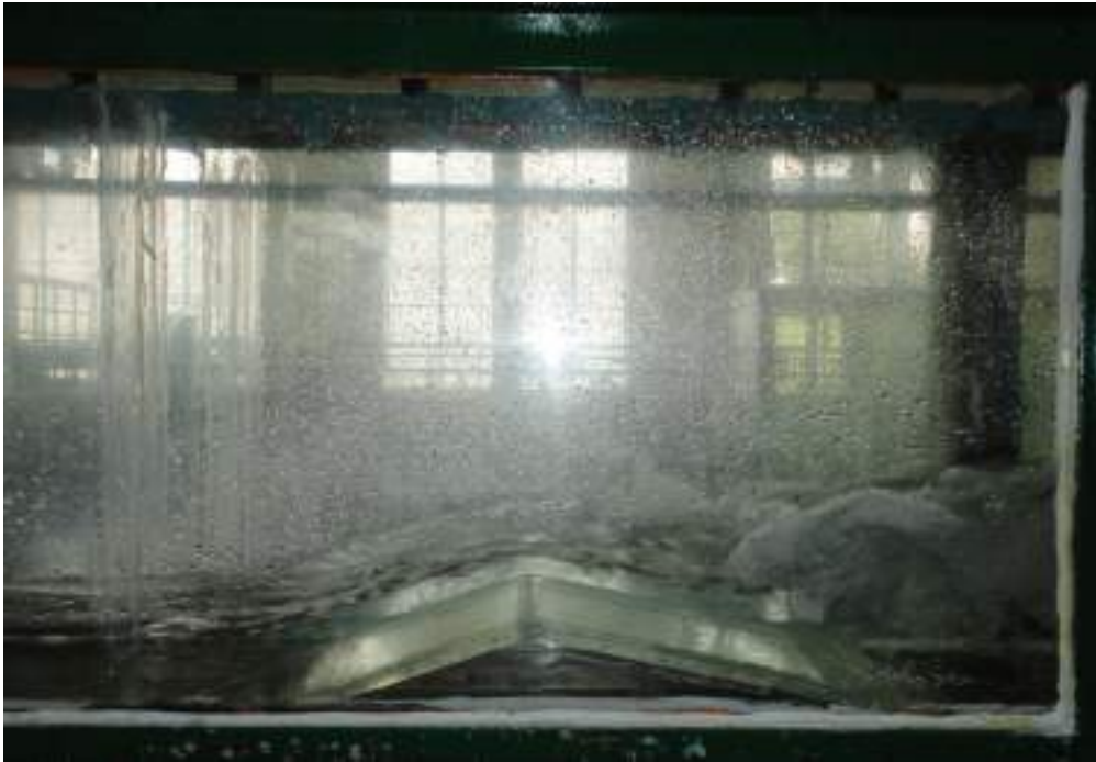
Figura 2.3-5: Inicio del resalto hidráulico, del ensayo 2.
