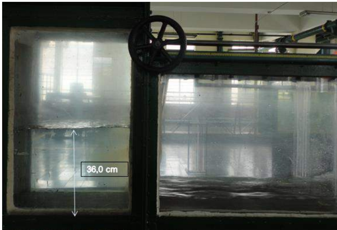
Figura 2.3-4: Flujo aguas arriba y aguas abajo de la compuerta, para el ensayo 2.
