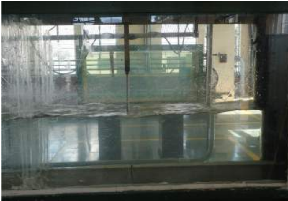
Figura 2.3-15: Superficie de agua, aguas abajo del resalto, para el ensayo 5.
