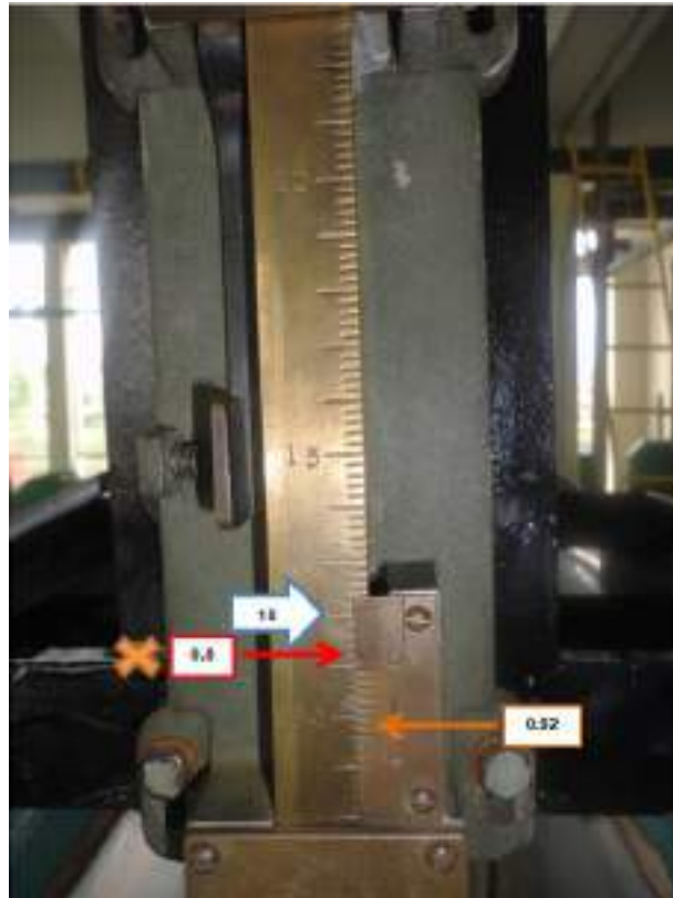
Figura 2.2-2: Ejemplo de la lectura del medidor de aguja.
