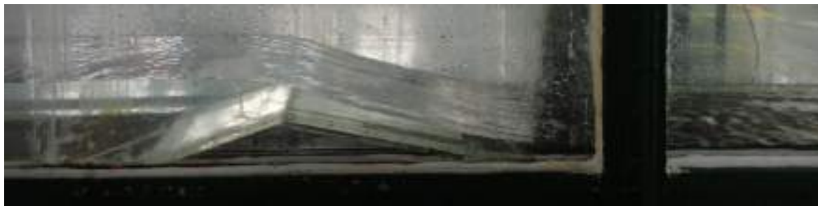
Figura 2.3-11: Caída hidráulica en el obstáculo, para el ensayo 4.
