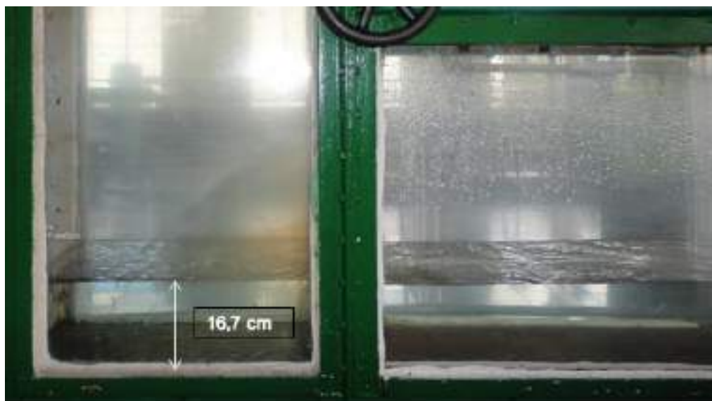
Figura 2.3-19: Flujo aguas arriba y aguas abajo de la compuerta, para el ensayo 7.
