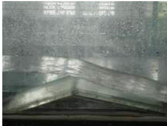
Figura 2.3-8: Caída hidráulica en el obstáculo, para el ensayo 3.
