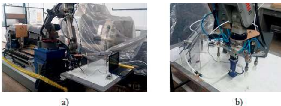
Figura 3. a) Adaptación de brazo robótico para aplicaciones en manufactura aditiva experimental. b) Instalación en detalle del extrusor en el brazo robótico
