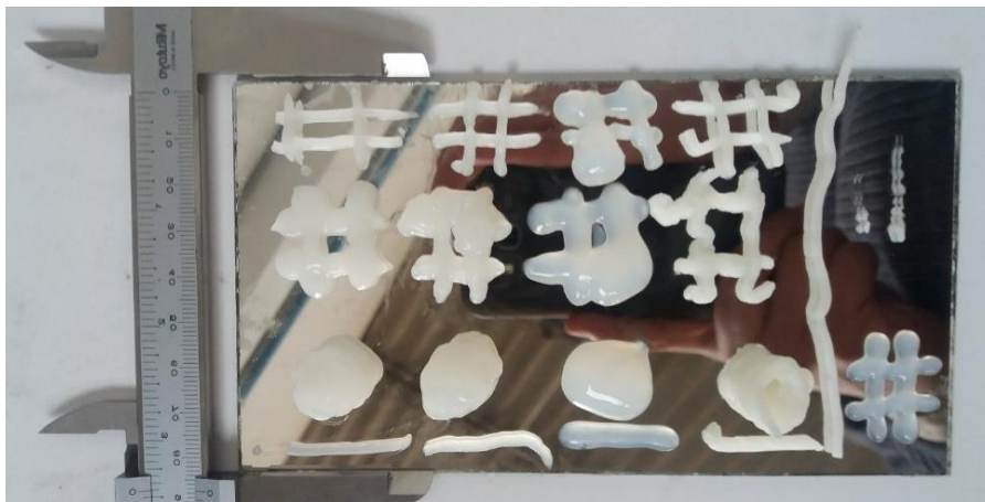
Figura 9. Evaluación de la capacidad de auto soporte preliminar
