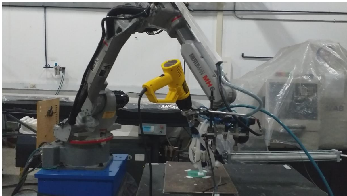
Figura 22. Plataforma experimental robotizada de AM por extrusión
