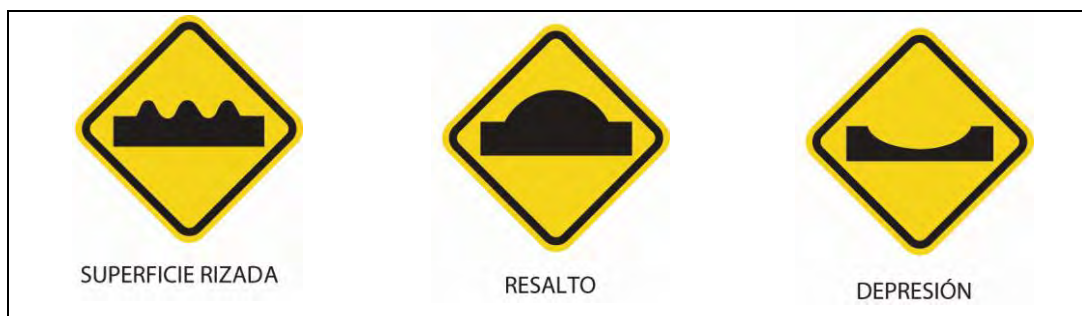
Figura 103 Señales que indican un perfil irregular
