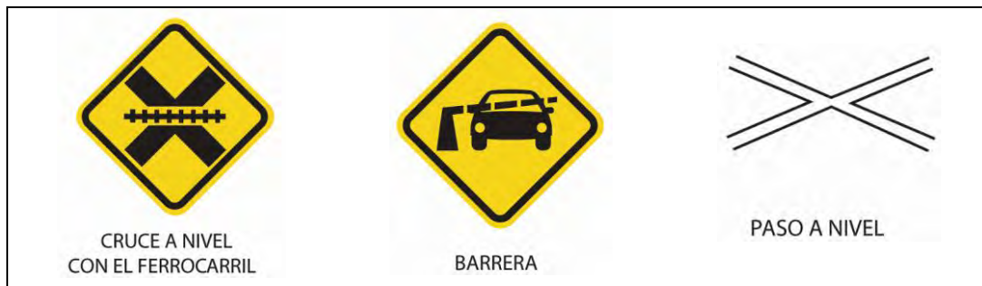
Figura 107. Señales preventivas para el paso a nivel
