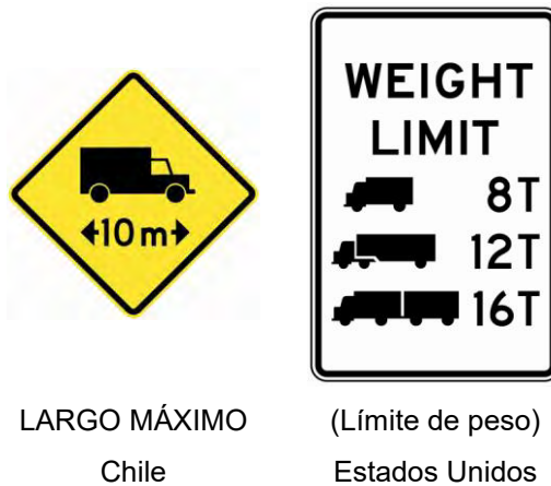
Figura 206. Limitaciones adicionales de circulación para camiones.
