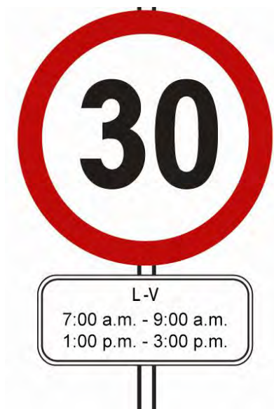
Figura 122. Señalización de velocidad máxima en zonas escolares
