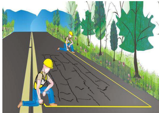
Figura 13. Falla en bloque 26
