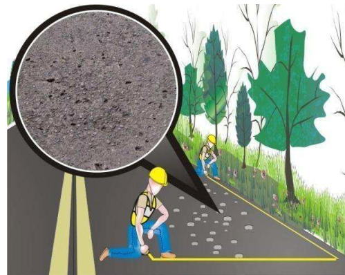
Figura 3. Pérdida parcial del agregado en tratamientos superficiales 15
