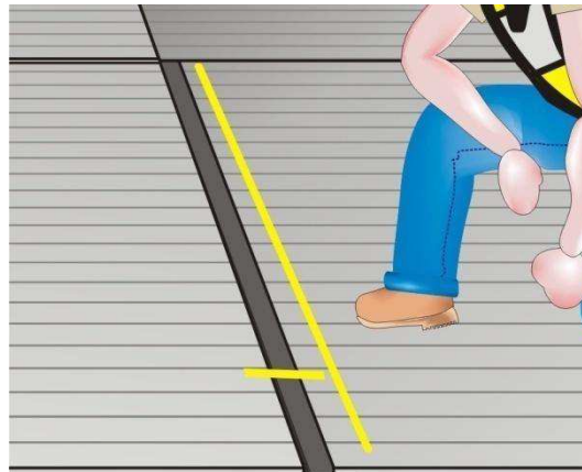
Figura 17. Separación de la junta longitudinal 30
