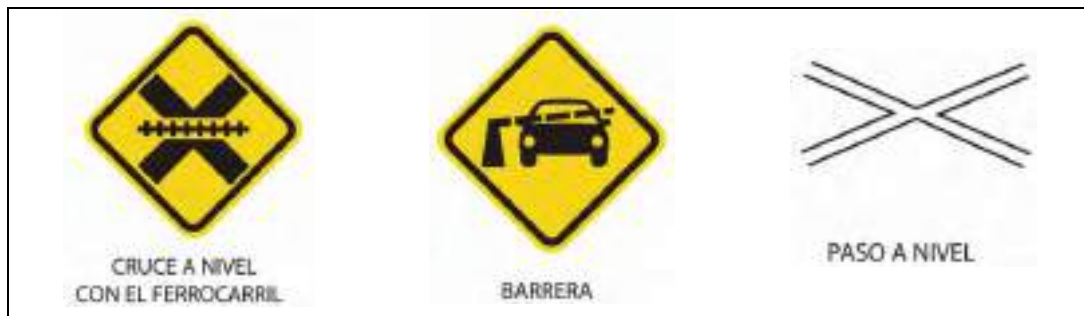
Figura 107. Señales preventivas para el paso a nivel
