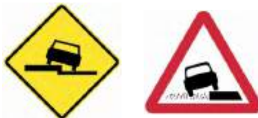
Figura 211. Señales preventivas de desnivel severo.
