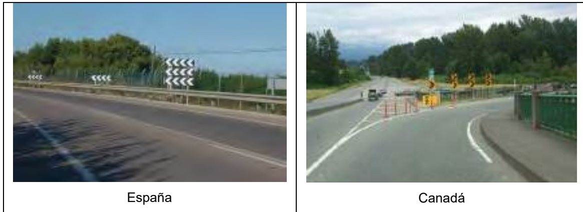
Figura 138 Uso de delineadores en curva en una carretera
