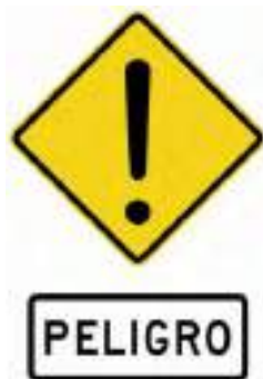
Figura 200. Señal de advertencia de peligro
