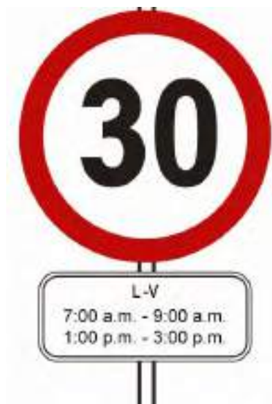
Figura 122. Señalización de velocidad máxima en zonas escolares
