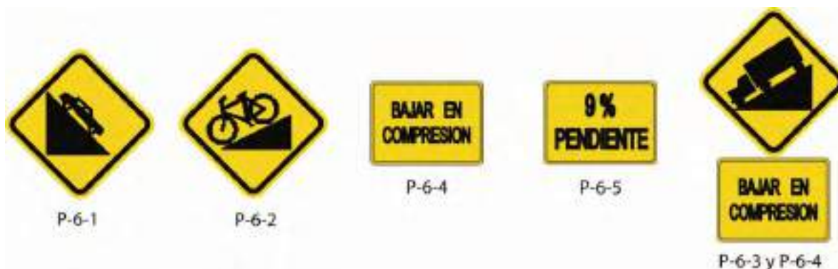
Figura 175. Señalización de ascenso y descenso utilizada en el manual centroamericano.
