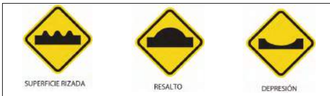
Figura 103 Señales que indican un perfil irregular
