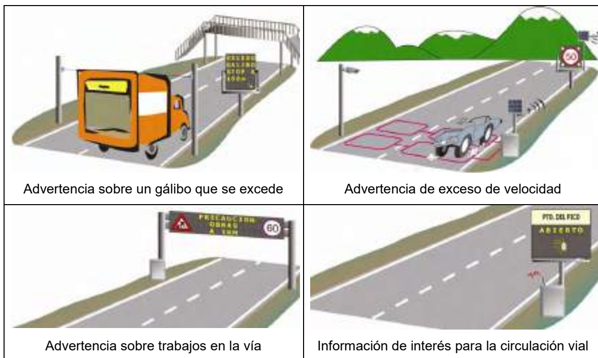
Figura 116. Diversos usos de la señalización dinámica
