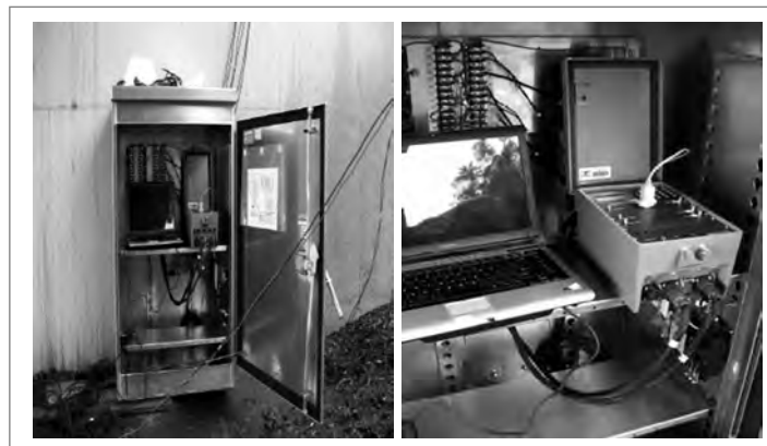
Figura 6. Gabinete con las conexiones electrónicas, el sistema suministrado por la empresa Canadiense IRD - International Road Dynamics Inc. y un computador para la adquisición de los datos de conteos y medición de los vehículos que circulan por el puente.
