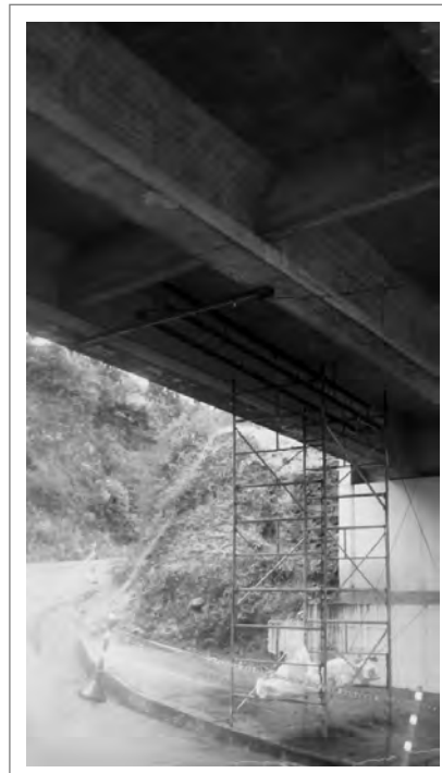
Figura 8. Instalación de los LVDT en el centro de las cuatro vigas preesforzadas principales del puente que permiten medir deformaciones verticales por el paso del tráfico sobre el puente
