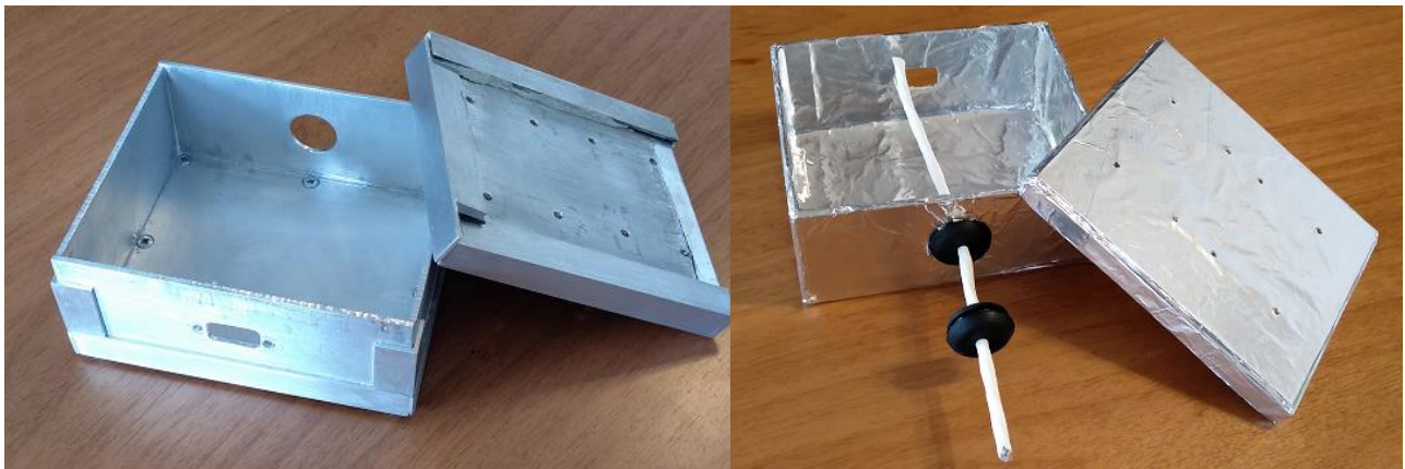
Figura 15. Horno interno construido con aluminio (izquierda) y cartón paja (derecha)
