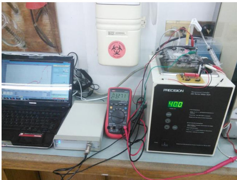
Figura 27. Montaje de una MFC basada en la cepa Clostridium IBUN 62F
