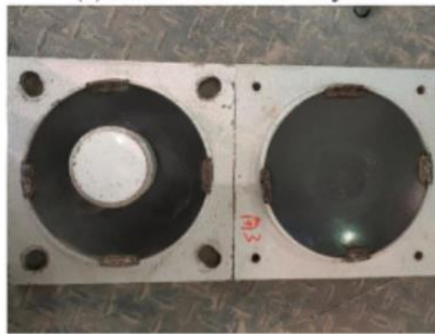
(d) DFPB after shaking table tests
