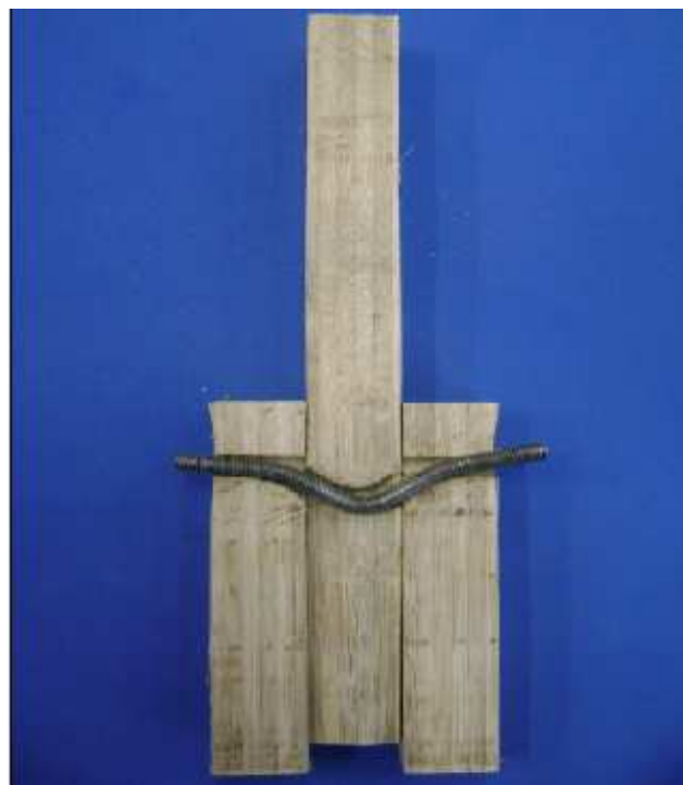
Figura 4.19. Modo IV de falla ,a) Deformación y esfuerzos modelo FEM, b) Deformación modelo experimental
