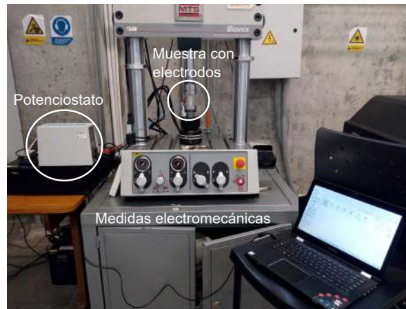
Figura 10: Configuración experimental implementada para verificar las propiedades piezoeléctricas de las muestras de cemento con y sin Au NPs.
