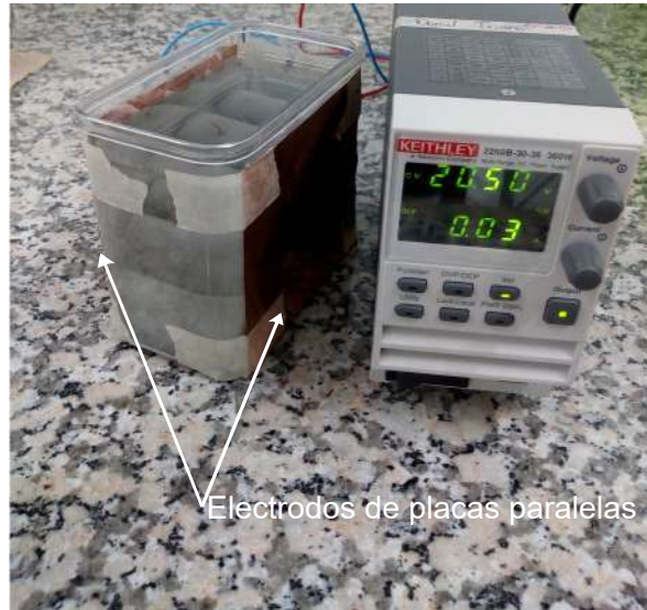
Figura 2: Muestras de cemento con nanocompuestos fraguadas bajo la acción de un campo eléctrico externo.
