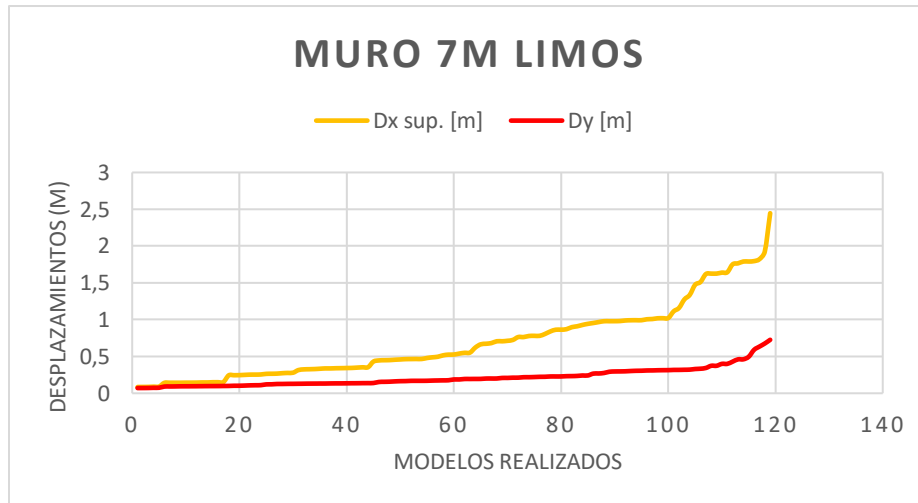
Imagen 44. Desplazamientos en muros de 7m de altura en limos
