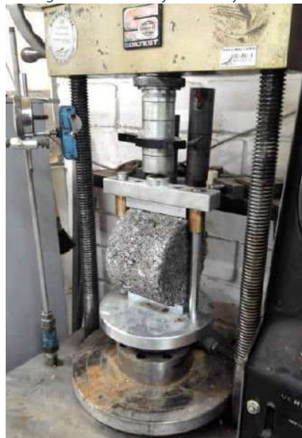
Figura 3.18 Montaje de Ensayo ITS.
