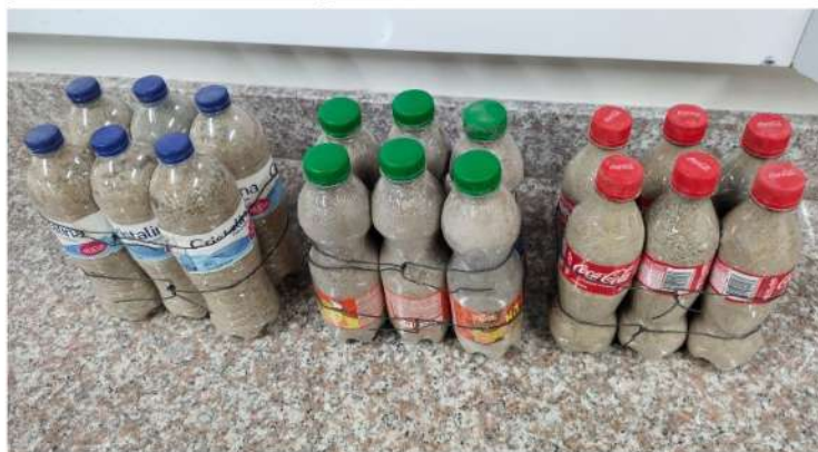
Figura 1. Bloques tipo para ensayos de laboratorio. Fuente: elaboración propia.
