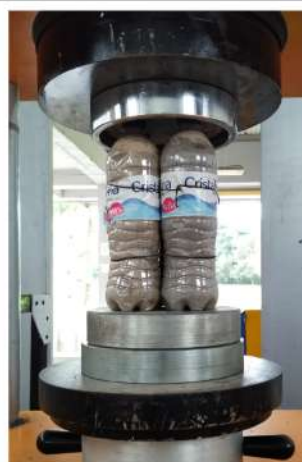
Figura 4. Bloque tipo 3 antes del ensayo. Fuente: elaboración propia.
