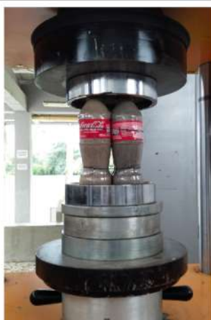
Figura 3. Bloque tipo 2 antes del ensayo. Fuente: elaboración propia.
