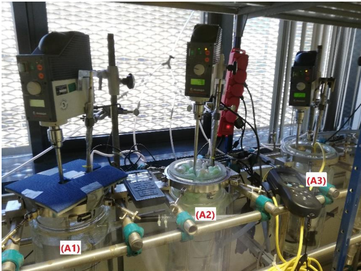
Bild 2: Aufbau der zweiten Versuchsreihe. A1 Reaktor mit Schaumdeckel, A2 mit Styroporkörnung und A3 ohne Deckel
