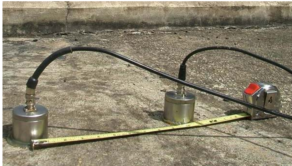
Figura 4-2: Sensores ubicados de manera indirecta. La grasa se aplica para permitir la transferencia al sensor y fijarlo a la superficie
