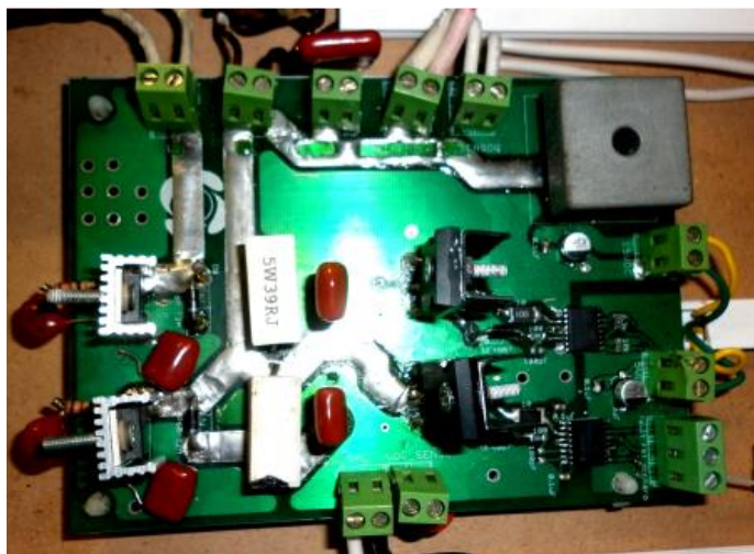
Figura 68. Circuito del convertidor AC-DC elevador sin puente
