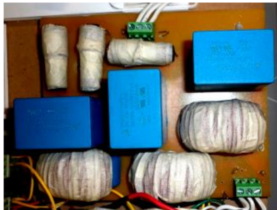
Figura 106. Circuito del filtro LCL
