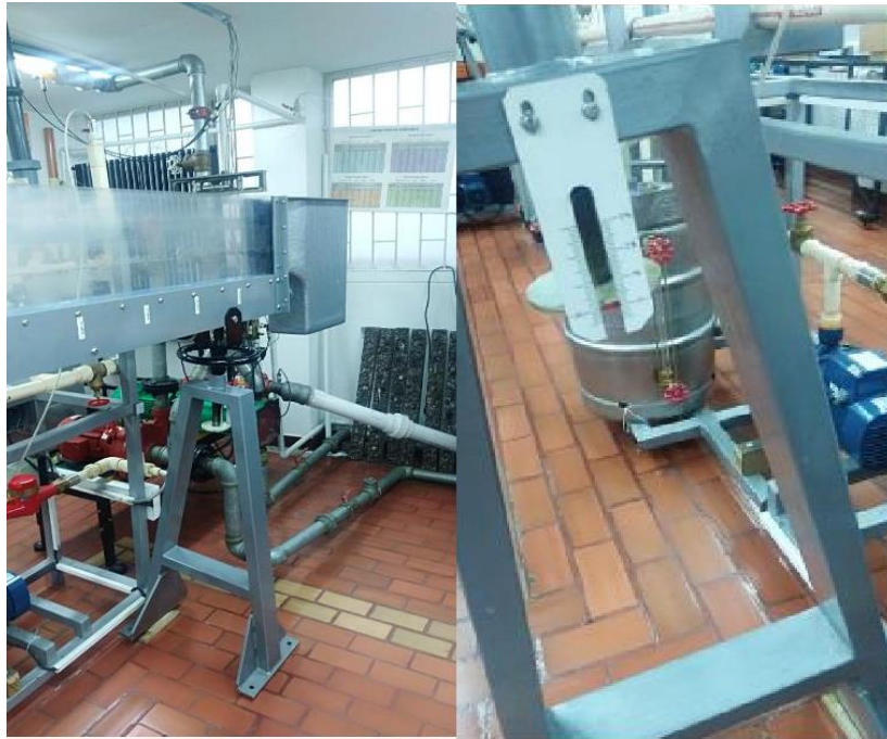
Figura 20. Canal y tablero de inclinación (%)
