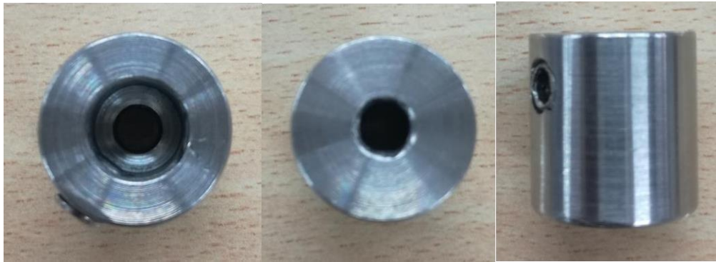
Figura 29. Acople dinamo a eje de hélice
