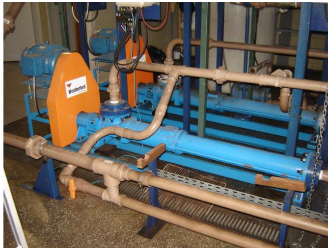
Figura 51. Bombas helicoidais de alimentação de água e óleo, Rodriguez (2009).
