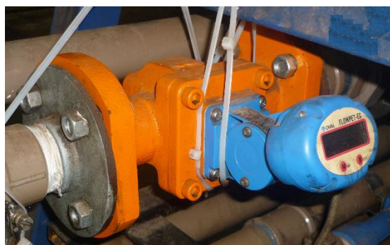
Figura 55. Medidores de vazão de óleo. a) Altas vazões; b) Baixas vazões.
