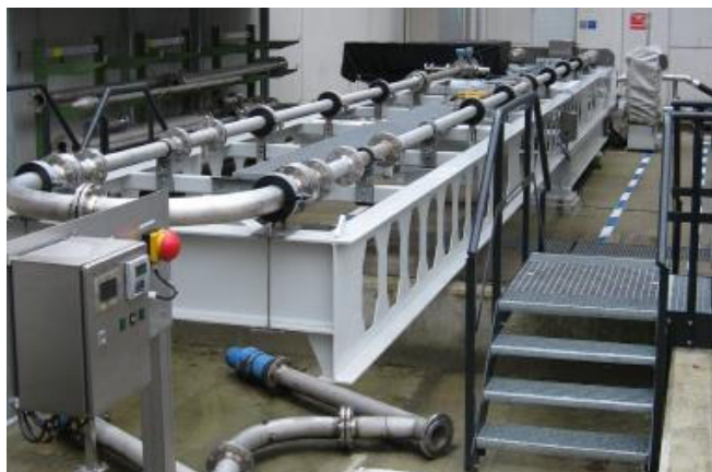
Figura 105: Seção de teste circuito multifásico DONAU da Shell Holanda.
