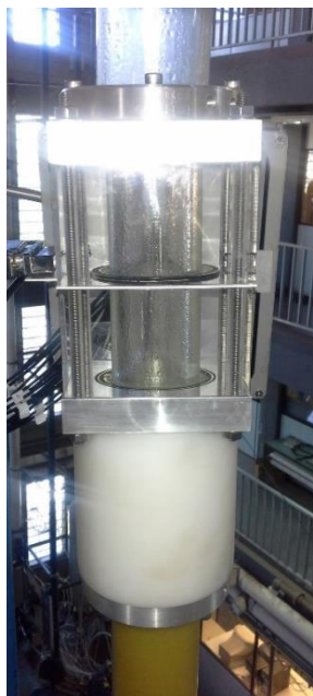
Figura 74. Montagem do flange, com caixa de visualização e wire-mesh na linha vertical.
