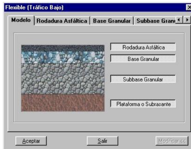
Figura 36 Modelo para pavimentos flexibles de bajo tráfico
