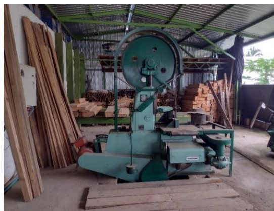
Imagen 12. Máquina sin fin de trabajo industrial para deshile de MAMW.
