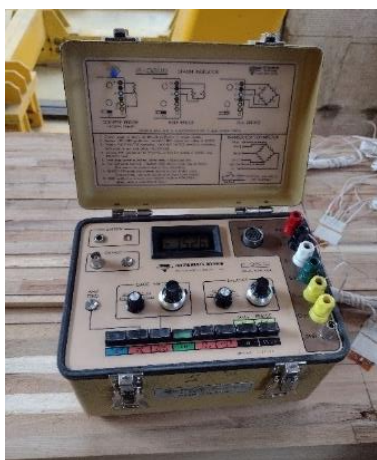
Imagen 47. Equipo indicador de deformación tipo INSTRUMENTS DIVISION P-3500
