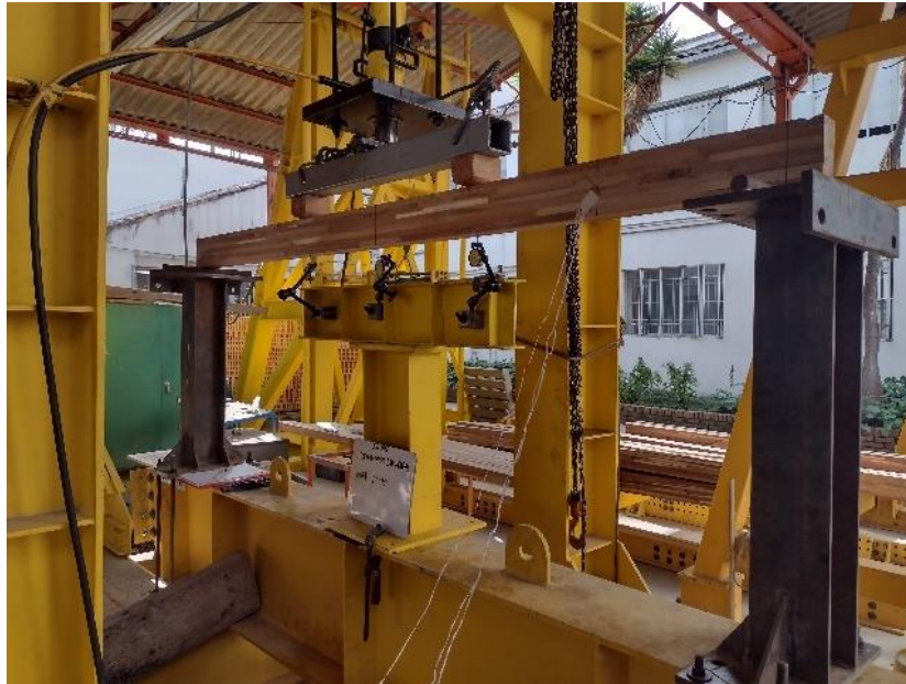
Imagen 49. Equipamiento e instrumentación en laboratorio para ensayos de flexión de 4 puntos con MLAMW con L > 2.0 m.
