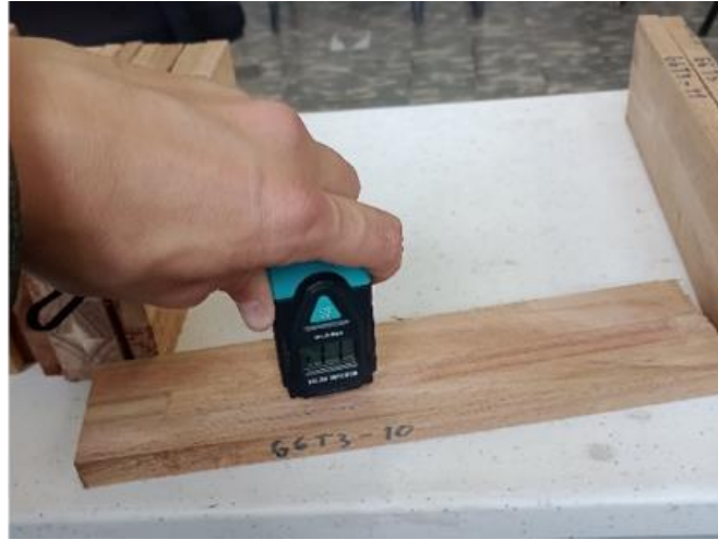
Imagen 41. Medición del contenido de humedad W\% con higrómetro digital sobre probeta MLAMW G6T3-10
