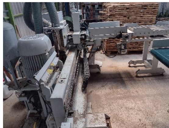
Imagen 22. Mini fresadora de espigas SFSh 009R BACKOUT.
