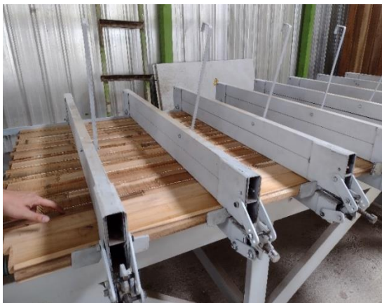
Imagen 29. Banco de prensado de MLAMW.
