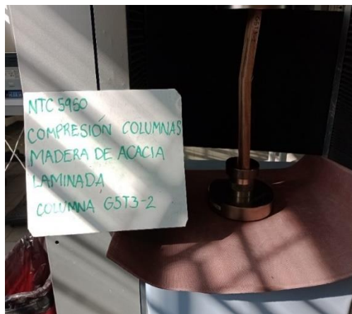
Imagen 54. Ensayo de compresión de la probeta G5T3-2.
