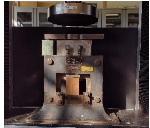
Imagen 44. Determinación de la resistencia al cizallamiento paralelo al grano \sigma_{cz} de la MAMW. Equipamiento en laboratorio.
