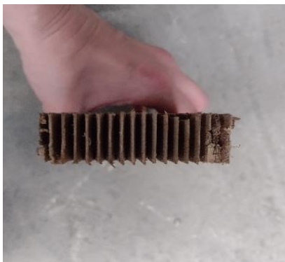
Imagen 23. Vista frontal de madera después del proceso de fresado en la línea de finger joint .
