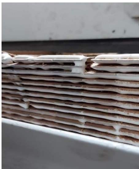
Imagen 25. Encolado con PVA de piezas de MAMW fresadas.
