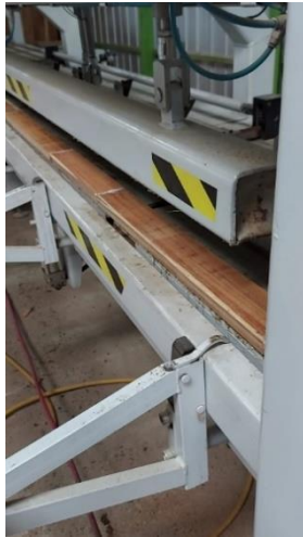
Imagen 27. Prensado longitudinal y transversal para cierre de finger joint.
