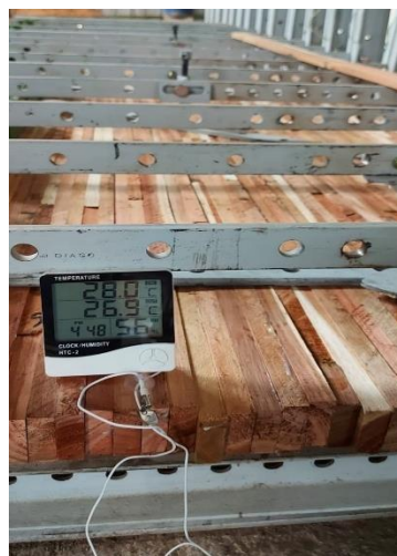
Imagen 30. Medición de temperatura de MLAMW.
