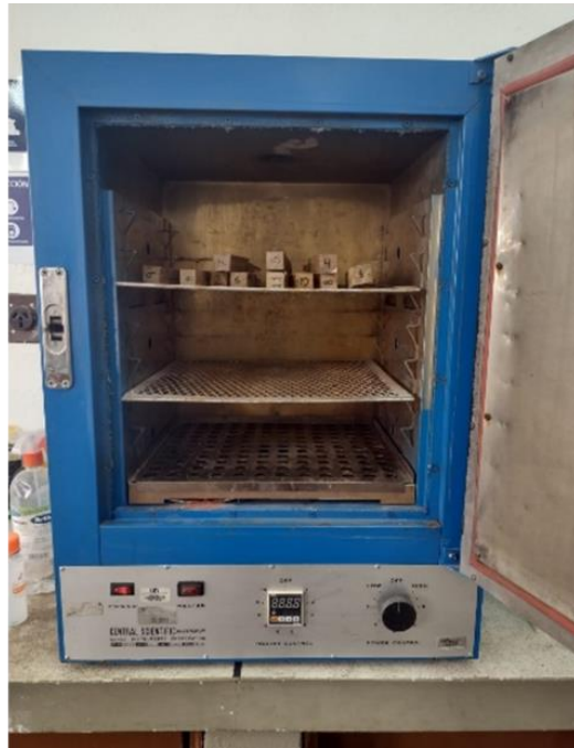
Imagen 39. Secado en horno para determinación del contenido de humedad W\% por el Método B de NTC 206-2.
