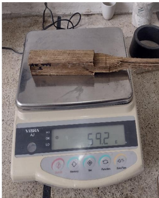
Imagen 38. Medición de peso para determinación del contenido de humedad W\% por el Método B de NTC 206-2
