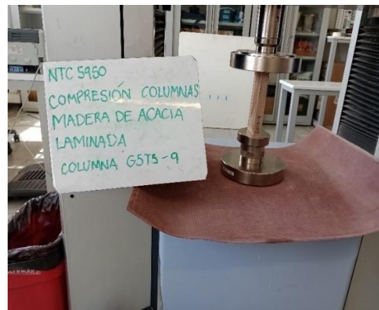
Imagen 55. Ensayo de compresión de la probeta G5T3-9.
