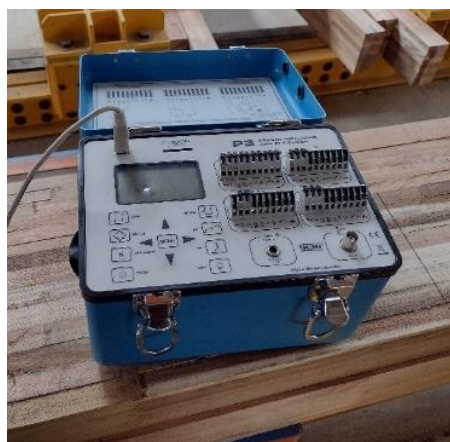
Imagen 48. equipo indicador de deformación tipo Micro-Measurements P3 Strain indicator and measurement
