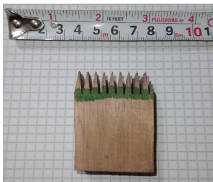
Imagen 24. Vista lateral de madera después del proceso de fresado en la línea de finger joint .
