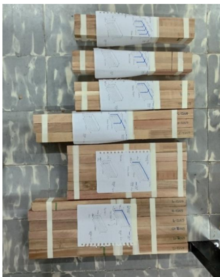
Imagen 36. Grupo de laminados para corte de probetas a compresión de MLAMW
