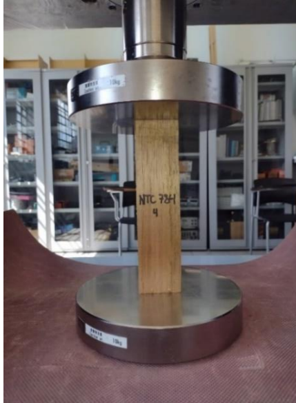
Imagen 42. Montaje de probeta NTC 784-4 en la máquina universal para ensayo de resistencia a la compresión axial o paralela al grano.
