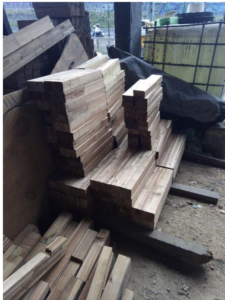
Imagen 34. Lote de MLAMW obtenida después del primer corte de los tercios centrales
