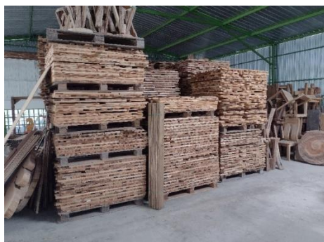
Imagen 20. Castillos de madera clasificados por dimensiones para ensamble de elementos de MLAMW.
