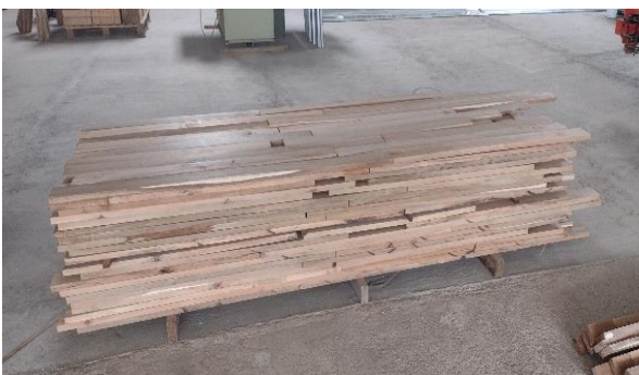
Imagen 19. MAMW cortada, canteada y cepillada.
