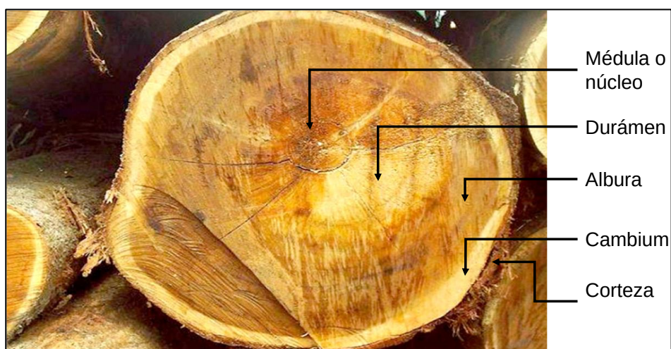
Imagen 6. Estructura anatómica de sección transversal tronco de Acacia mangium Willd. Adaptado de (Arbocenter, 2022), https://www.sementesarbocenter.com.br/sementes-de-acacia-mangium.html
