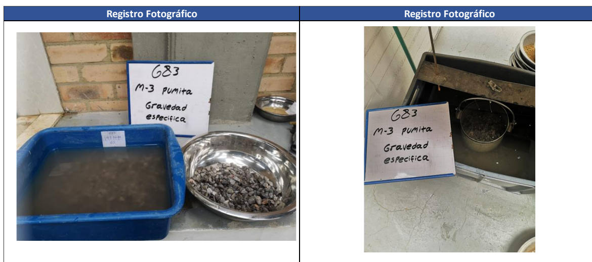
Ilustración 13 Aparatos de laboratorio Densidad y Absorción Roca Pumita- Fuente: Propia
