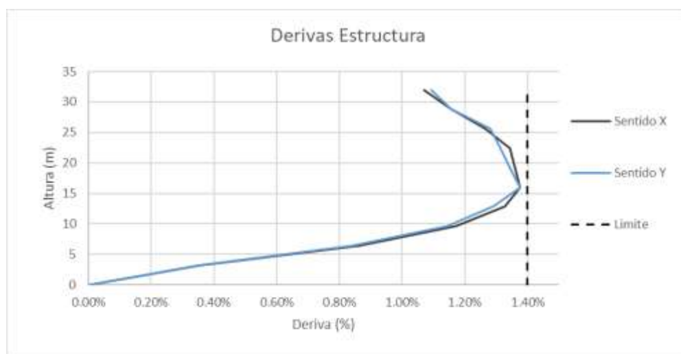
Figura. 15. Esquema de las derivas en ambas direcciones sísmicas.
