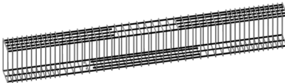
Figura. 16. Refuerzo viga. Ejes E-F
