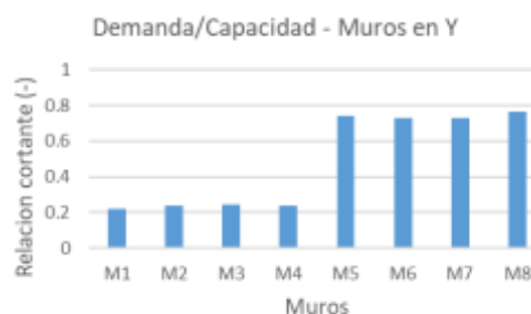
Figura. 44. Demanda/Capacidad - Muros en Y.
