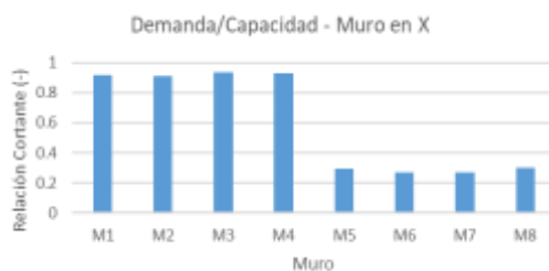
Figura. 54. Demanda/Capacidad - Muros en X
