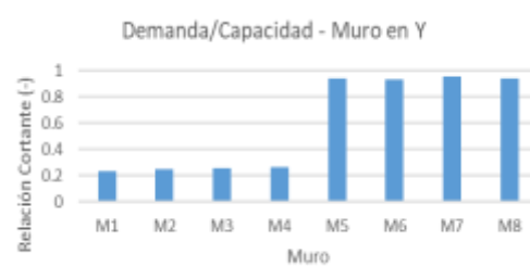
Figura. 55. Demanda/capacidad - Muros en Y
