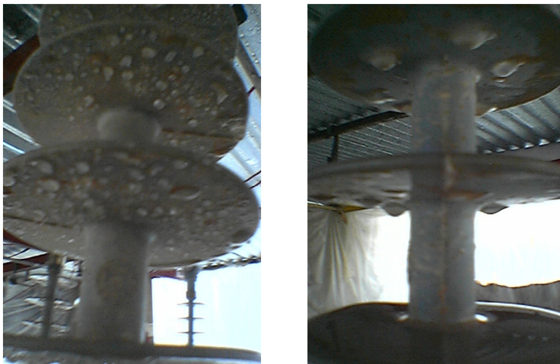
Fig. 42. Aislador con sal (izquierda) y aislador con Caolín (derecha)
