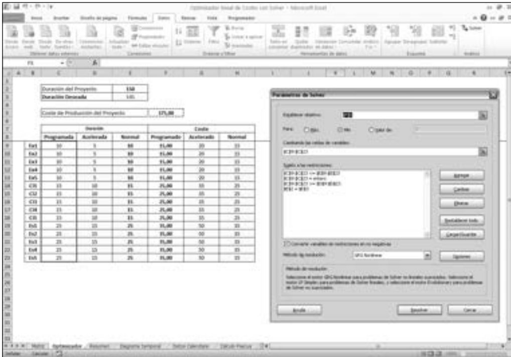
Figura 6.13. Parámetros Solver del modelo lineal.
