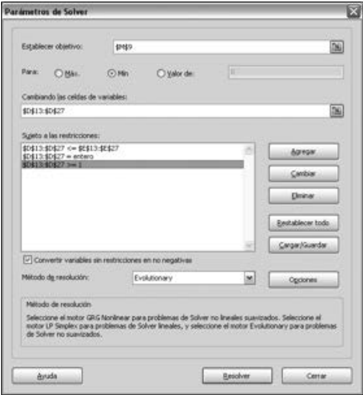
Figura 6.20. Parámetros Solver del modelo no lineal.
