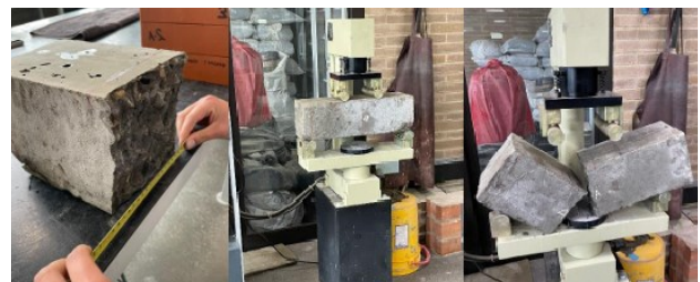
Imagen 2. Realización de un ensayo de módulo de rotura.
