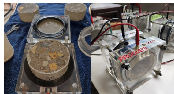
Imagen 3. Realización de un ensayo de penetración de iones cloruro.
