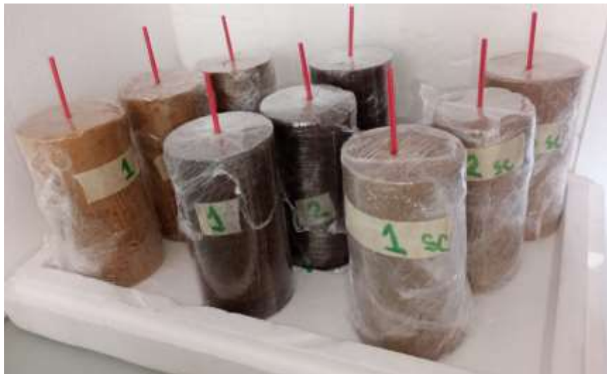
Figura 64. Preparación de las muestras de suelo cemento.
