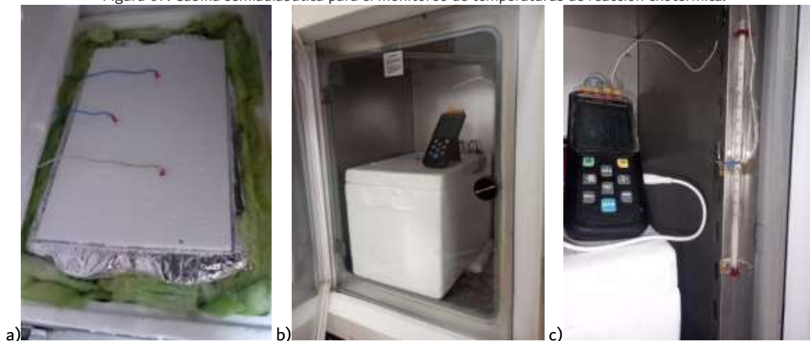
Figura 67. Cabina semiadiabática para el monitoreo de temperaturas de reacción exotérmica.
