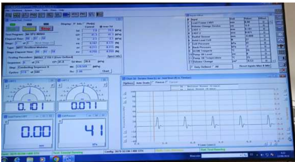
Figura 91. Registro visual del ensayo y diagrama de pulsos de carga con su respectiva deformación.
