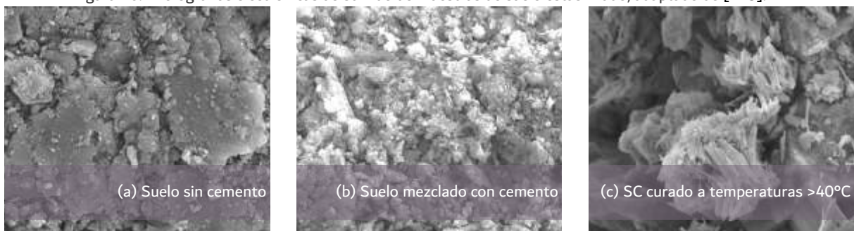
Figura 20. Micrografías electrónicas de barrido de muestras de suelo estabilizado, adaptado de [215].
