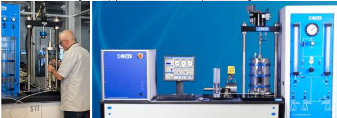
Figura 88. Equipo Triaxial cíclico GCTS usado para esta investigación.
