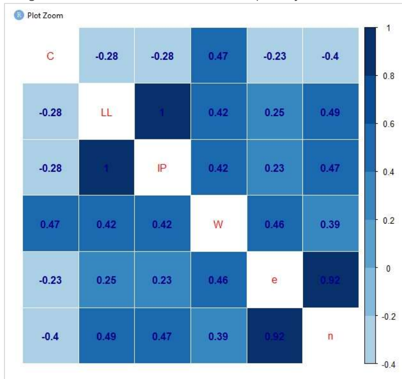
Figura 44. Diagrama de multicolinealidad entre las variables que influyen en la Conductividad térmica.
