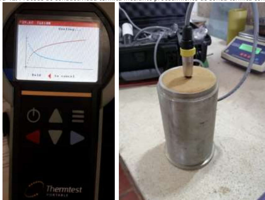
Figura 41. Pruebas de conductividad térmica mediante procedimiento de sonda térmica con aguja.
