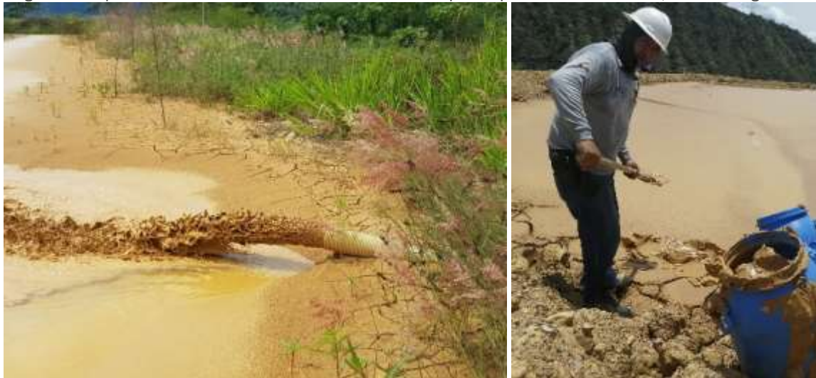
Figura 28. Depósito de residuos arcillosos del lavado de arenas para la producción de concreto, Mina T.S. Ingeniería.
