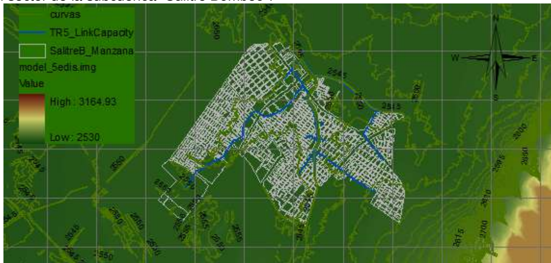
Figura 6-47. Modelo de elevación digital corregido de 5m para la ciudad de Bogotá en el sector de la subcuenca “Salitre Bombeo”.
