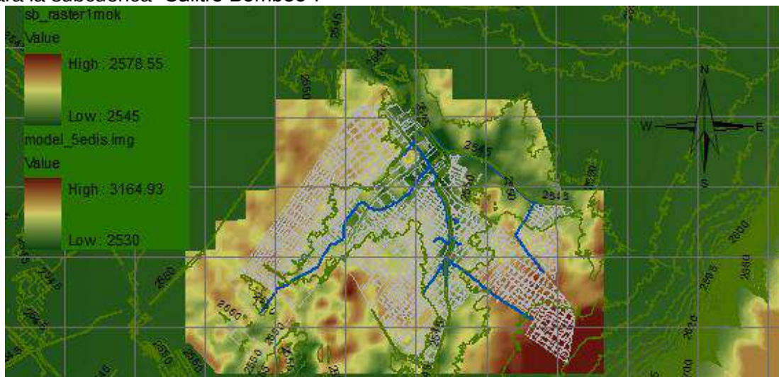
Figura 6-48. Modelo de elevación digital generado de 0.1m entre valores de elevación para la subcuenca “Salitre Bombeo”.
