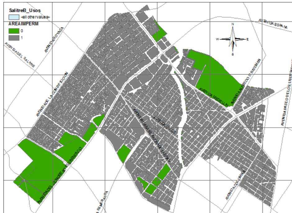
Figura 6-49. Manzanas de la subcuenca “Salitre Bombeo” en relación con su porcentaje de impermeabilización.
