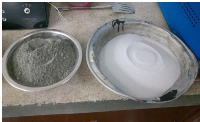
Figura 4-15 A la izquierda cemento Portland. A la derecha arena de Ottawa. Cantidades necesarias para la mezcla.
