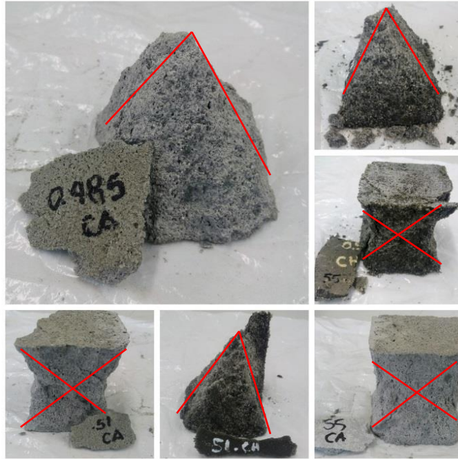
Figura 4-13 Cubos de mortero tras el ensayo de resistencia a la compresión. . Las líneas rojas resaltan las superficies de fractura
