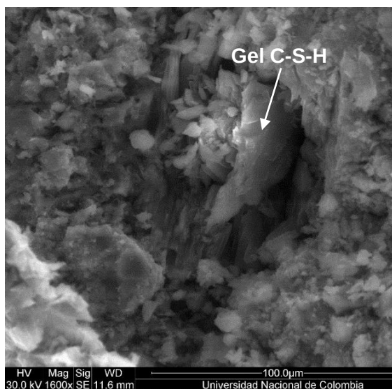
Figura 5-15 Microfotografía SEM - SE. Láminas de gel C-S-H. Muestra de cemento 0,29 CA a 28 días
