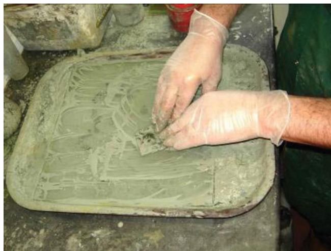
Figura 4-18 Pulido manual sobre un vidrio. Tomado de Concrete Petrography (Alan B. Poole, 2016)
