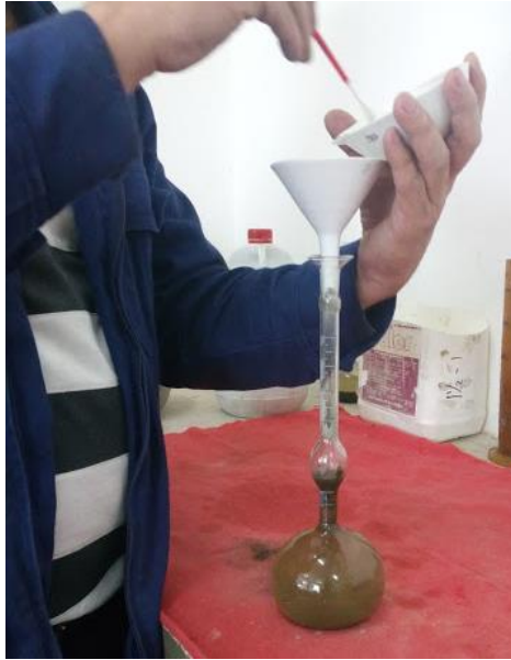
Figura 4-1 Ensayo de densidad. Se observa el frasco de Le Chatelier con kerosene y la manera en que se introduce el cemento.
