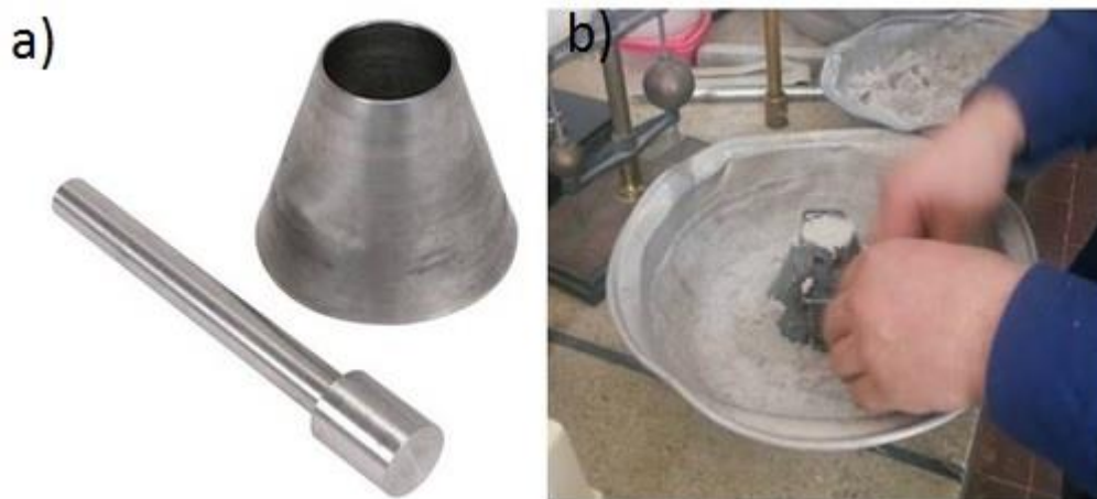
Figura 4-5 a) Cono de absorción de arenas con pisón. b) Cono lleno con arena saturada.
