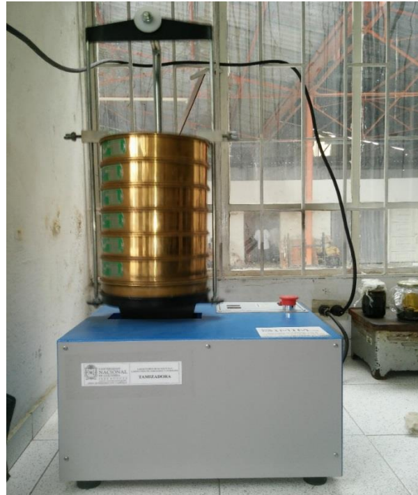
Figura 4-3 Tamizadora y tamices empleados para realizar la granulometría del agregado fino.
