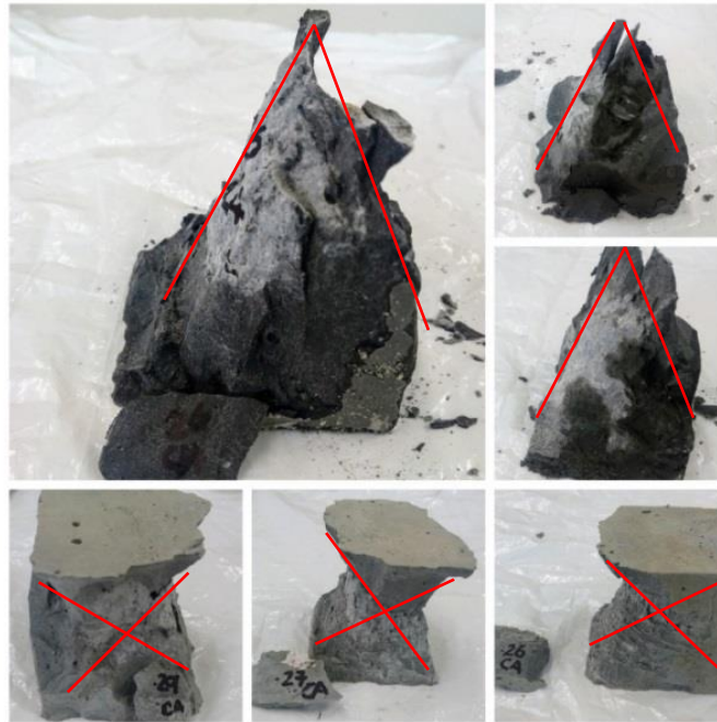
Figura 4-11 Cubos de pastas de cemento fallados en forma de reloj de arena. Arriba: curado húmedo. Abajo: curado ambiente. Las líneas rojas resaltan las superficies de fractura. La parte superior de los cubos en el curado húmedo se disgregó con la mano para observar con claridad el cono remanente, en el curado ambiente se mantuvo la identidad del remanente del cubo tras el ensayo.
