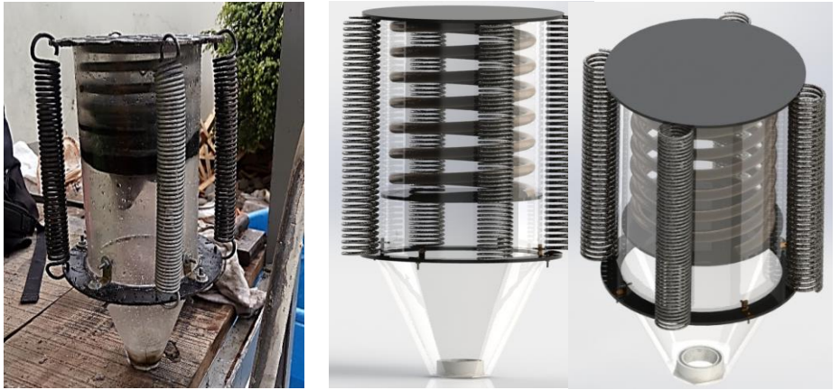
Figura 5. (a) Amortiguador Supresor de Sobrecarga. (b) Vistas semifrontal e isométrica; [4].
