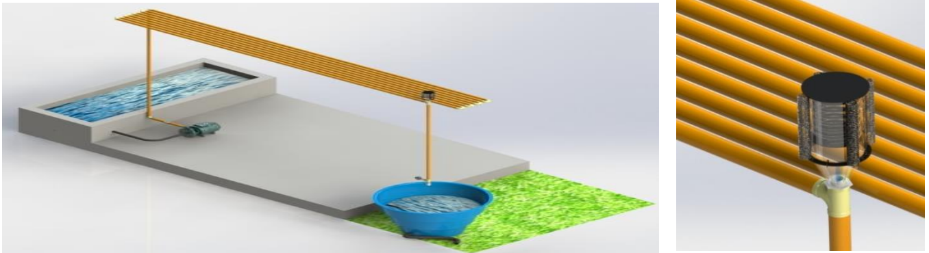
Figura 6. Detalle del montaje con Amortiguador Supresor de Sobrecarga; [4].
