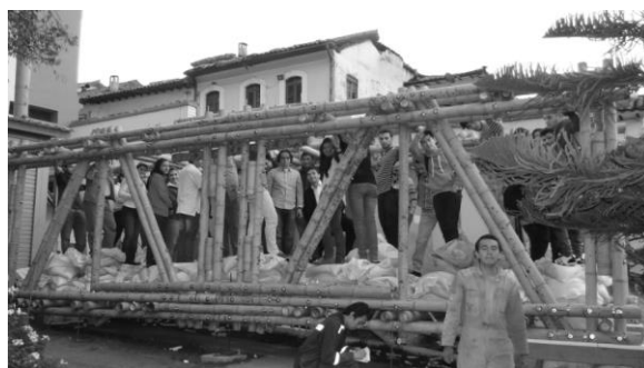
Figura 8: Prueba de carga a puente peatonal en guadua angustifolia, pensado principalmente para zonas rurales. Universidad de La Salle, Bogotá D.C., Colombia (2013).
