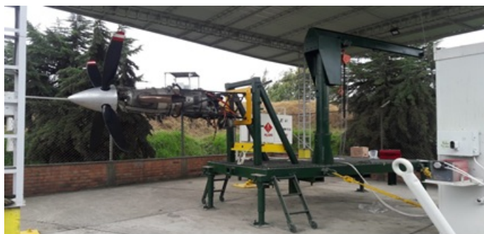
Figura 1 Conjunto Celda de pruebas para Biocombustibles
