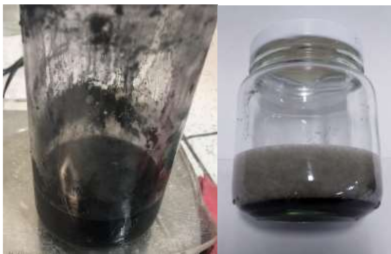
Figura 27. Producto de la reacción con generación de H 2 in situ.
