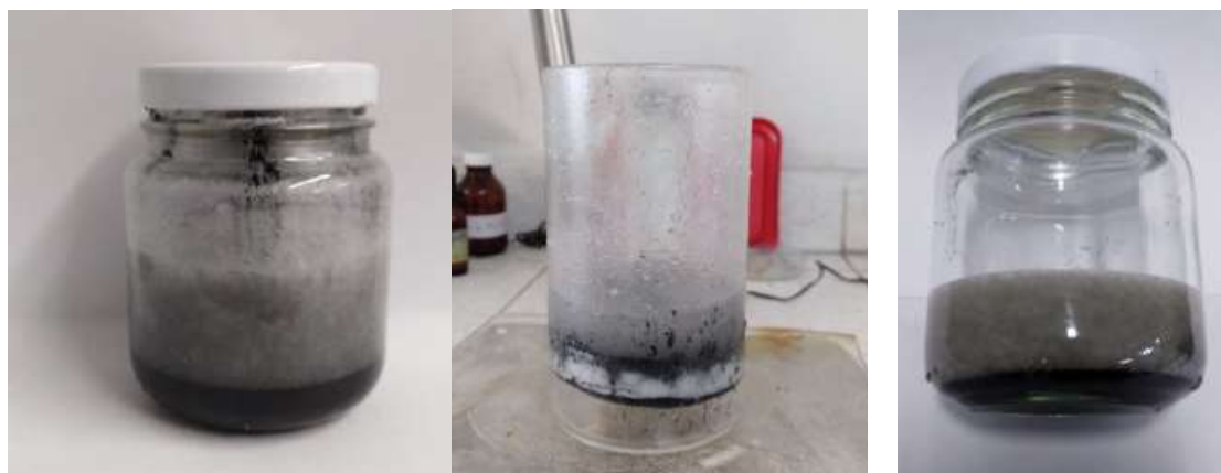
Figura 39. Descarga ensayo al 10%. Actual (Izq.), Anterior (centro) de 8 h e inicial (der.) de 4 h.
