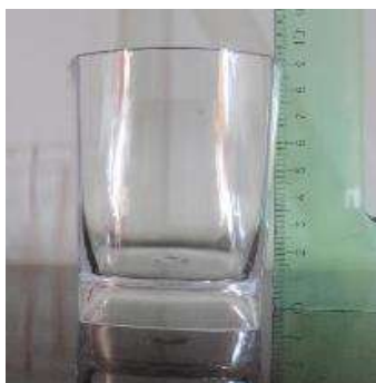
Figura 20: Trampa de sedimentos para recolección en tiempo continuo con capacidad de 8 oz.
