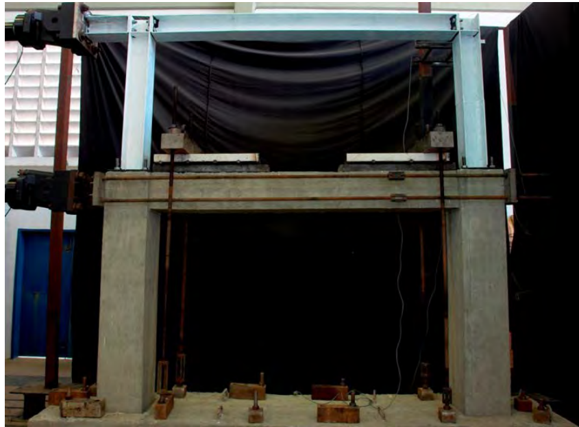
Figura 3.23. Pórtico mixto de dos niveles
