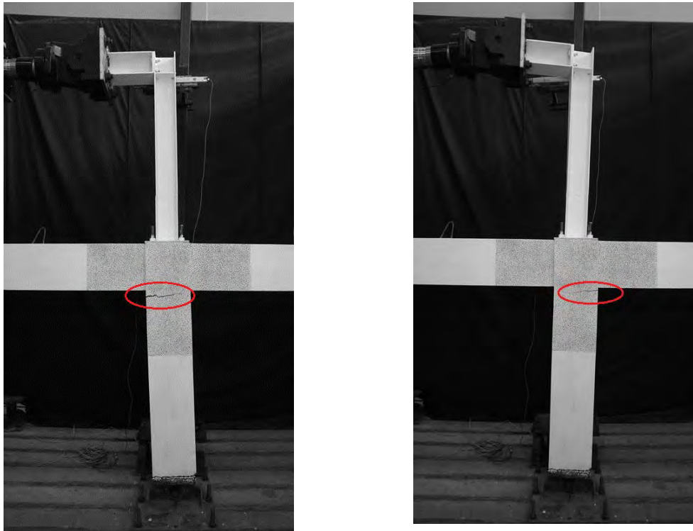
Figura 4.13. Composición gráfica de los puntos de colapso en los ciclos positivos y negativos. A la izquierda el ciclo negativo y a la derecha el ciclo positivo
