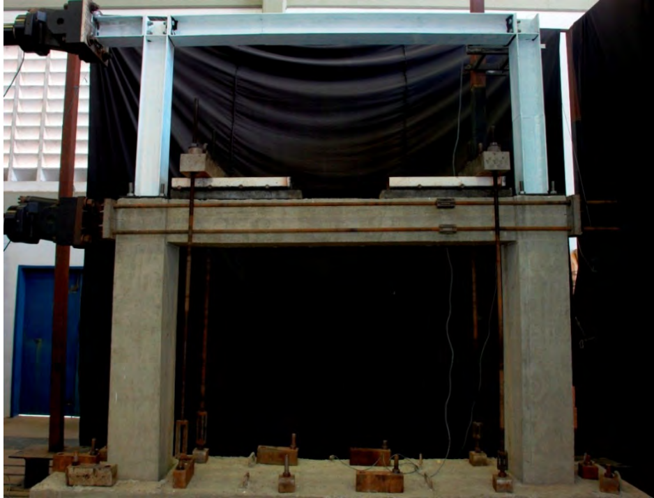
Figura 4.2 Vista general del pórtico Ensayo 1 donde se observa el nivel superior de acero y el nivel inferior de hormigón armado.
