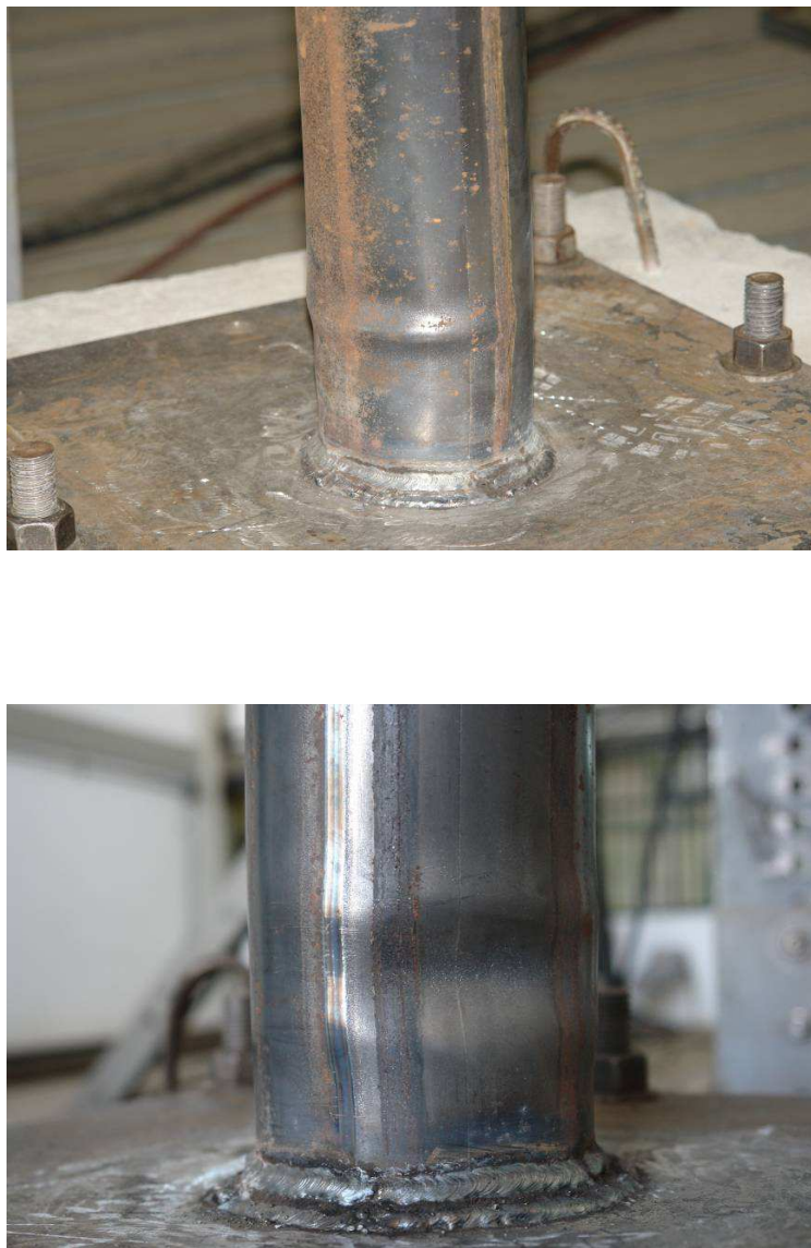
Figura 10. Aspecto del pandeo local del perfil tubular sometido a cargas biaxiales
