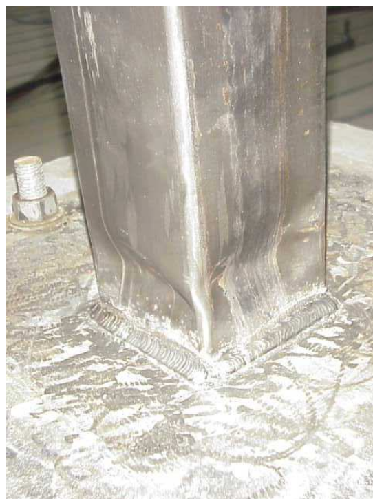
Figura 6. Aspecto del pandeo local del perfil tubular cuadrado. a) sometido a cargas uniaxiales. b) sometido a cargas biaxiales
