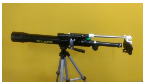
Figura 2: Primer prototipo del sistema de sujeción del equipo móvil al telescopio adaptando un Selfie Stick .
