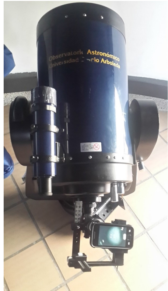
Figura 5: Pruebas de conexión del adaptador del móvil en un telescopio Meade de 10 pulgadas.
