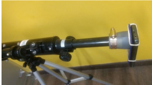
Figura 3: Segundo prototipo del sistema de sujeción del equipo móvil al telescopio.
