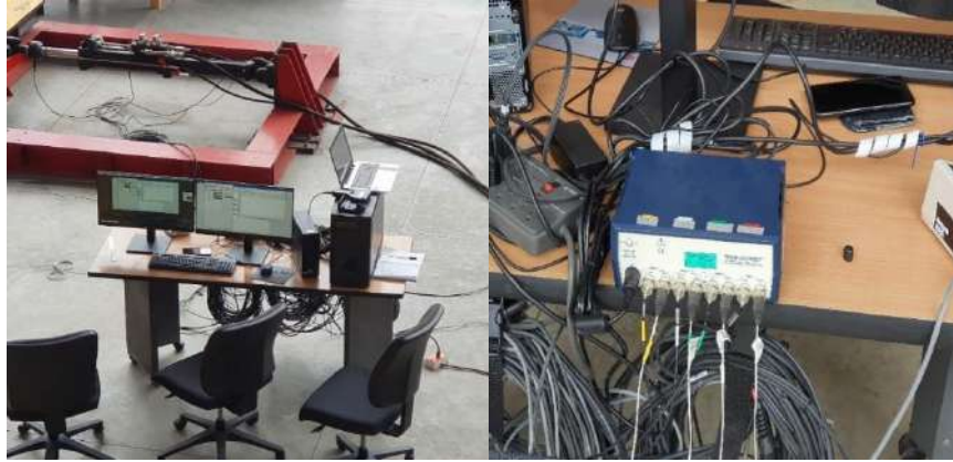
Figura 4–1: Estación de control de la mesa sísmica del laboratorio de estructuras de la universidad Nacional de Colombia sede Manizales
