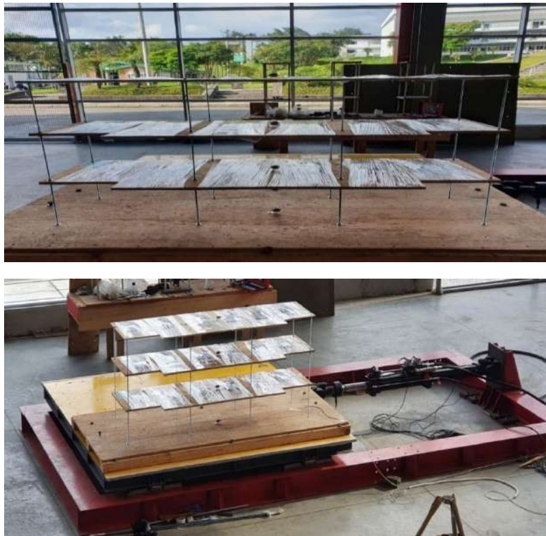
Figura 4–3: Perspectivas del modelo estructural de la institución educativa sobre la Mesa Sísmica – Laboratorio de Estructuras- Universidad Nacional de Colombia, sede Manizales
