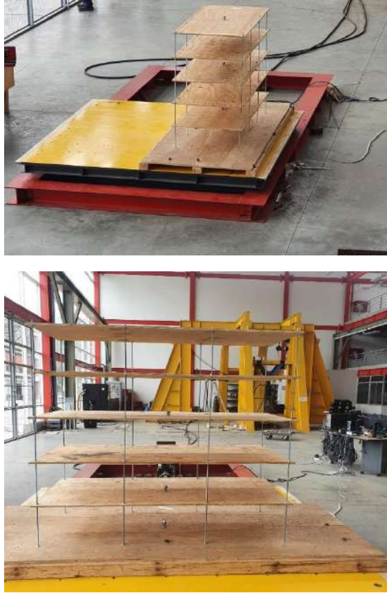
Figura 4–5: Perspectivas del modelo estructural residencial sobre la Mesa Sísmica – Laboratorio de Estructuras- Universidad Nacional de Colombia, sede Manizales
