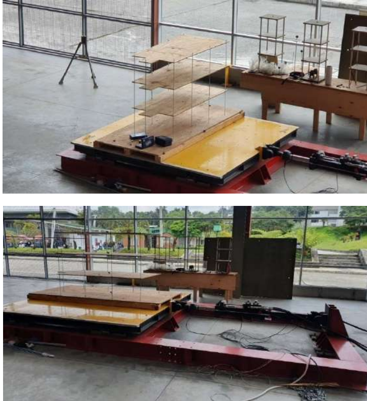
Figura 4-4: Perspectivas del modelo estructural de las oficinas y locales comerciales sobre la Mesa Sísmica – Laboratorio de Estructuras- Universidad Nacional de Colombia, sede Manizales
