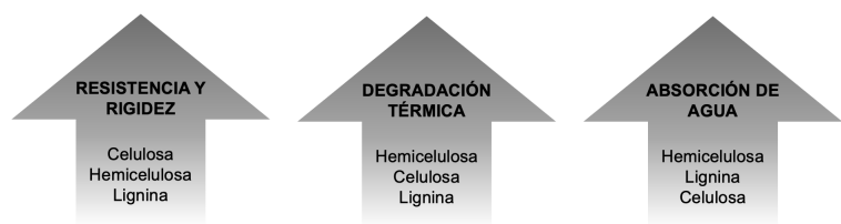
FIGURA 1. Dependencia entre la composición química y algunas propiedades de las fibras naturales. Adaptado de Rangappa et al. [16].
