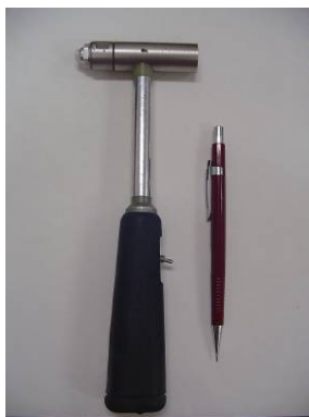
Figura 3-8 - Martelo ENVEDCO modelo 30927 com sensibilidade de 99.7 mV/lbf, com máxima força impulsiva aplicada de 1.00 lbf
