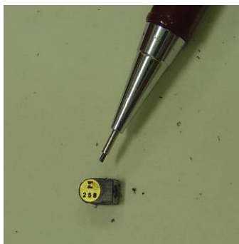
Figura 3-6 - Acelerômetro ENVEDCO modelo 25B S/N BL47 com sensibilidade de 4.7902 mV/g.
