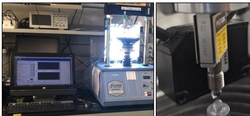
Figura 8. Vista general del montaje experimental utilizado para la formación y evaluación de puentes capilares entre esferas de borosilicato.
